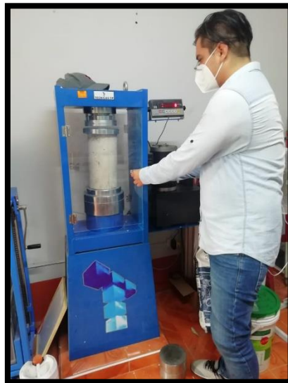
Preparación de las briquetas de concreto previo a su rotura.
