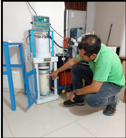
Preparación de las briquetas de concreto previo a su rotura.
