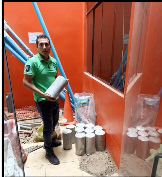
Probetas de concreto premezclado 75 muestras de estudio en total
