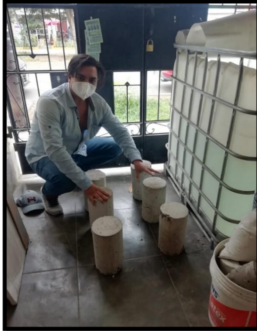
Preparación de las briquetas de concreto previo a su rotura.
