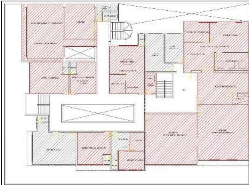
Figura 103 Ambientes críticos en hacinamiento que no cumplen con las áreas mínimas en la edificación existente - Segundo Nivel.
