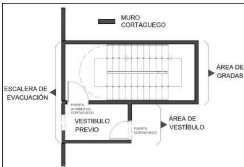
Figura 63 Áreas de la escalera de evacuación.
