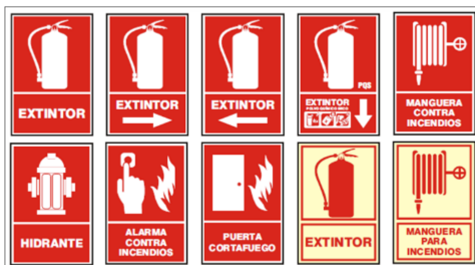
Figura 196 Señalización de equipos de prevención y protección contra incendios.
