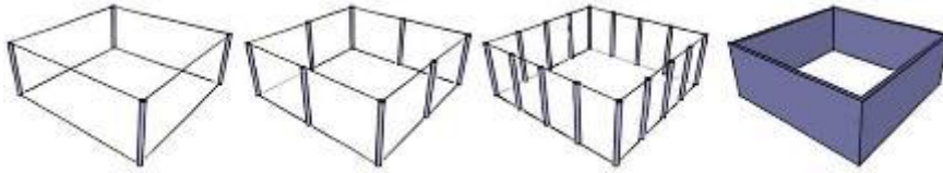
Figura 47 Delimitación de un espacio mediante columnas.
