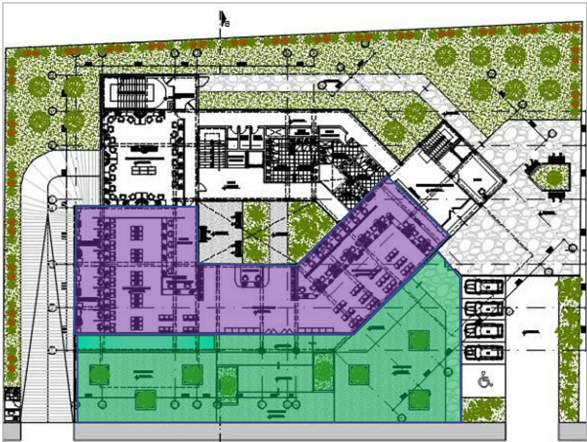
Figura 159 Zonificación – Primer piso
