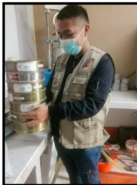
Realización del ensayo de granulometría de forma manual
