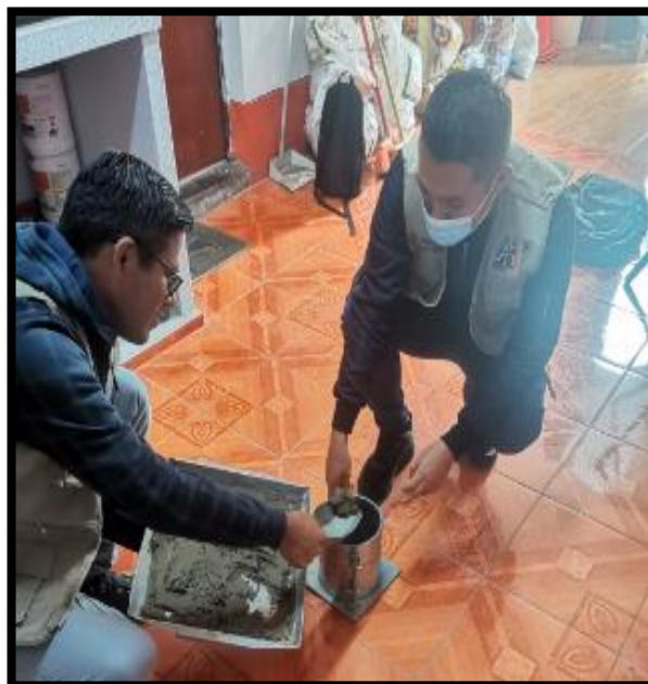
Colocación de cada una de las capas de muestra en el molde de Proctor modificado.
