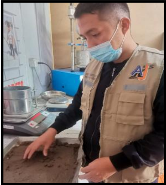
Humectación de la muestra de suelo utilizada para el Proctor modificado
