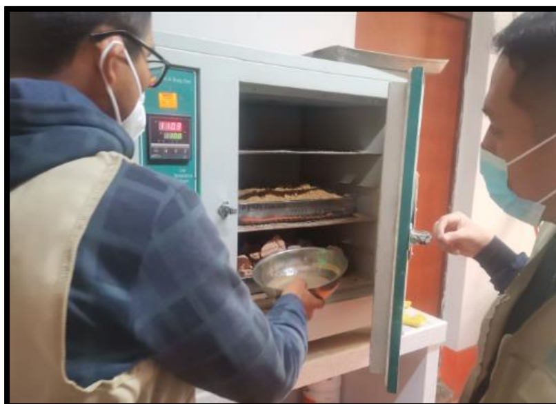
Colocación de muestra húmeda del suelo en el horno para su secado.
