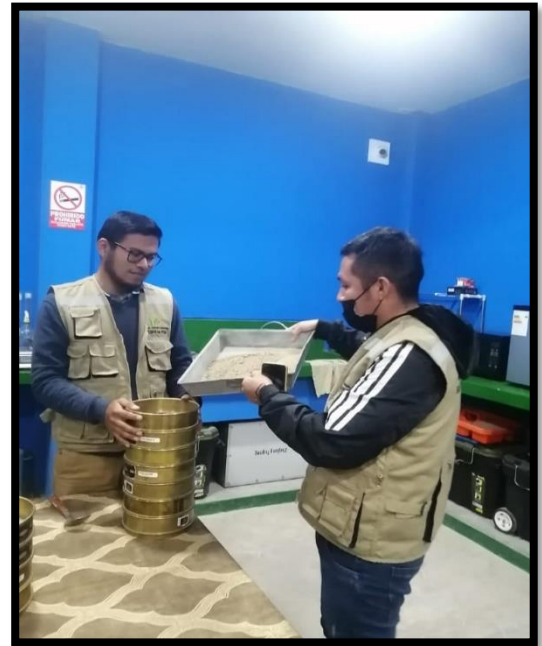
Muestra utilizada para la elaboración del ensayo de granulometría.
