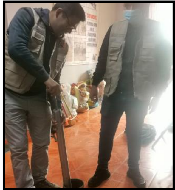
Desarrollo del ensayo de Proctor modificado
