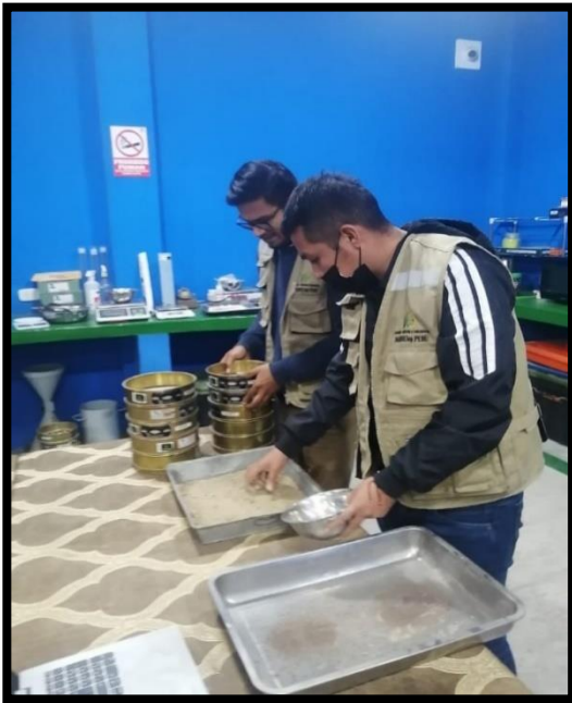
Colocación de la muestra de suelo en los tamices para realizar el ensayo de granulometría.
