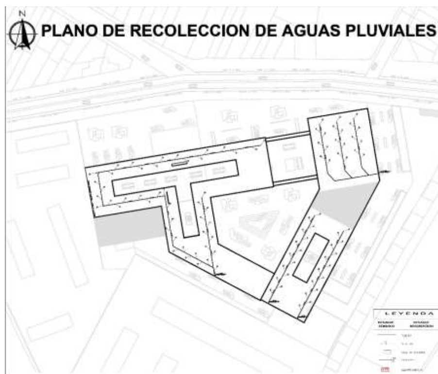
Imagen 94: Plano de recolección de aguas pluviales
