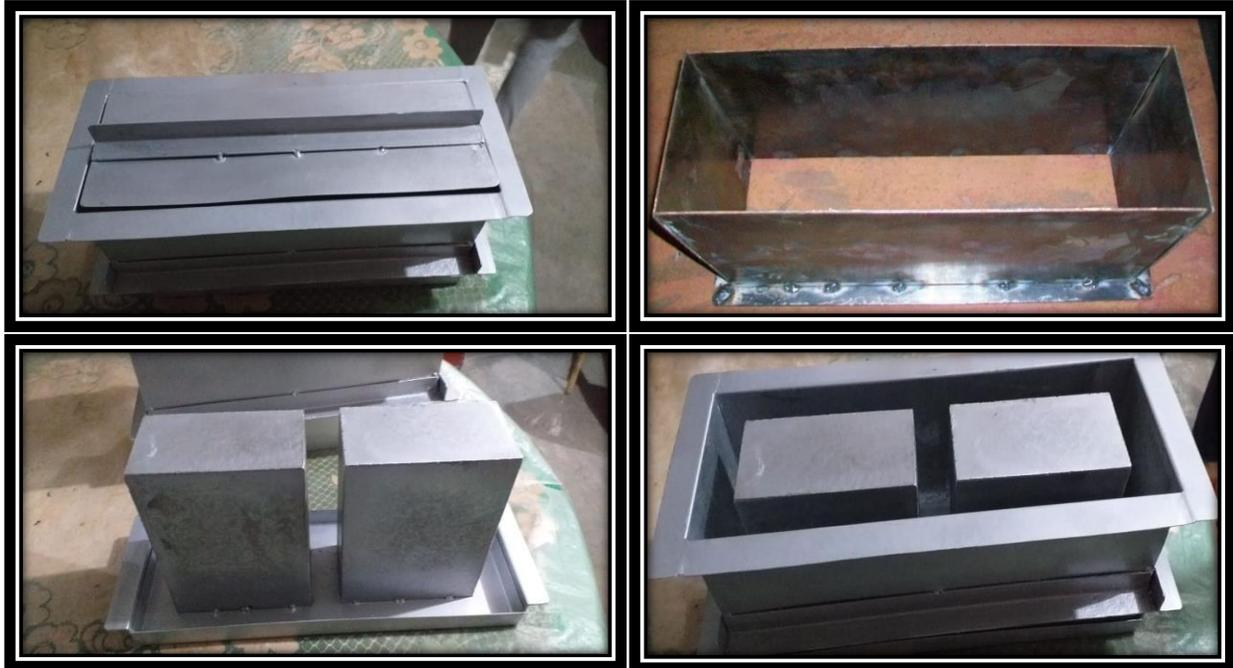
Nota: Podemos Observar en la Grafica Molde para el bloque según la Normas de Albañilería del Perú, elaborado con platino para una mayor duración. Elaboración Propia.
