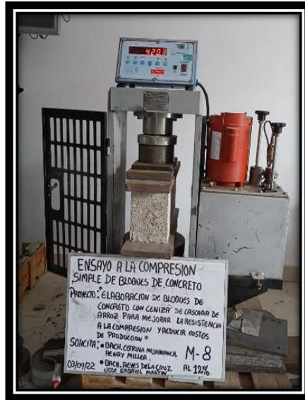
Nota: Observamos en la Grafica los Ensayos de compresión con el cuarto grupo de los nuevos bloques de concreto con el 12% de ceniza cascara de arroz. Elaboración Propia.
