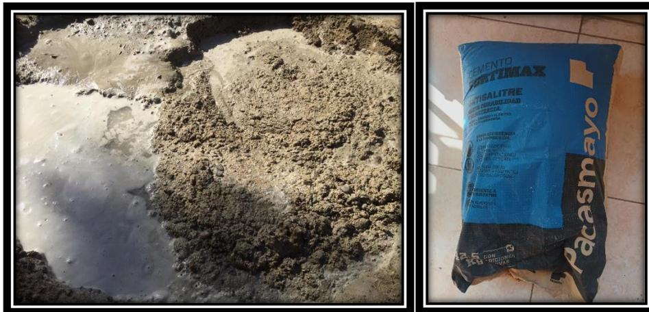
Nota: Podemos Observar en la Grafica la mezcla homogénea con los agregados de cemento, garbancillo, ceniza de cascara de arroz y agua para poderlo introducir al molde. Elaboración Propia.
