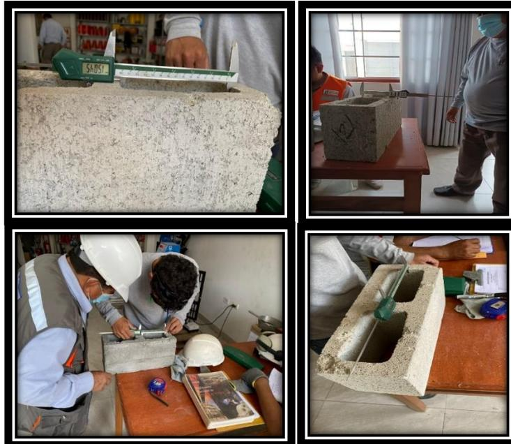
Nota: Podemos Observar en la Grafica las respectivas mediciones de los nuevos bloques de concreto con el vernier y apuntados en la bitácora para su posterior reporte de las pruebas. Elaboración Propia.
