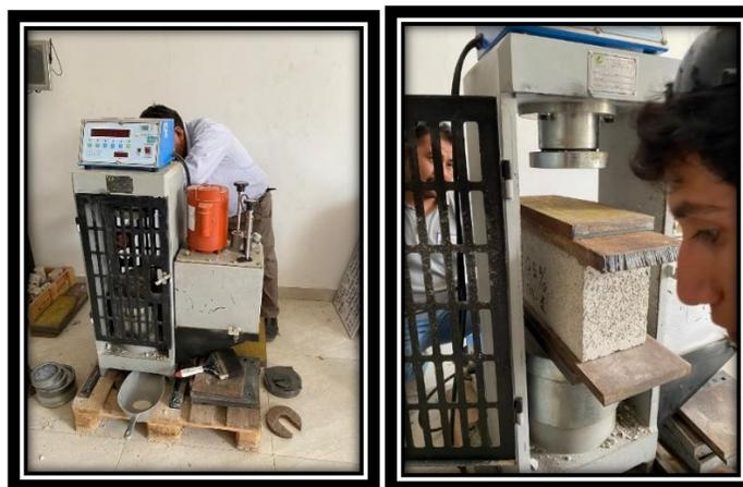
Nota: Podemos Observar en la Grafica la prensa que usaremos para los ensayos de compresión de los 15 bloques elaborados con la ceniza de cascara de arroz. Elaboración Propia.
