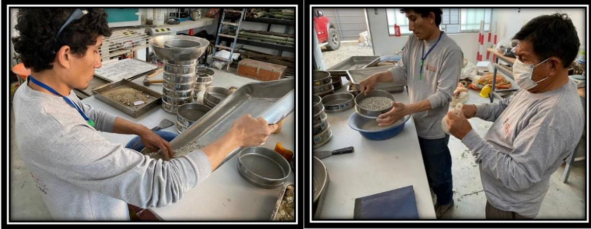
Nota: Observamos en la Grafica como el técnico, después de triturar los bloque lo pasan por un tamiz para filtrar los escombros finos y grueso. Para luego realizar el método de la probeta. Elaboración Propia.
