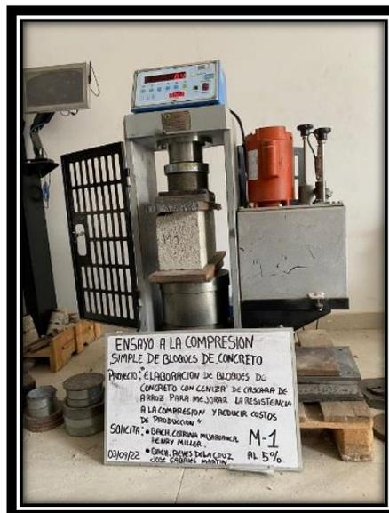
Nota: Observamos en la Grafica los Ensayos de compresión con el primer grupo de los nuevos bloques de concreto con el 5% de ceniza cascara de arroz. Elaboración Propia.
