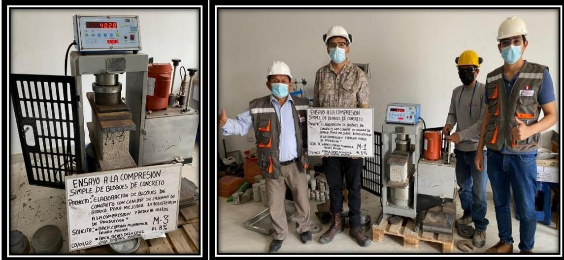
Nota: Observamos en la Grafica los Ensayos de compresión con el segundo grupo los nuevos bloques de concreto con el 8% de ceniza cascara de arroz. Elaboración Propia.
