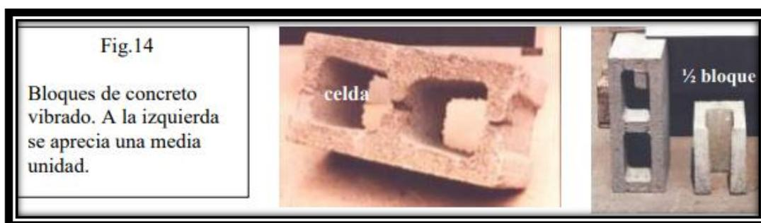
Nota: Las características cruciales de un bloque de concreto, tanto por sus celdas y el tamaño. Fuentes: (NTP - 399.601, 2006).
