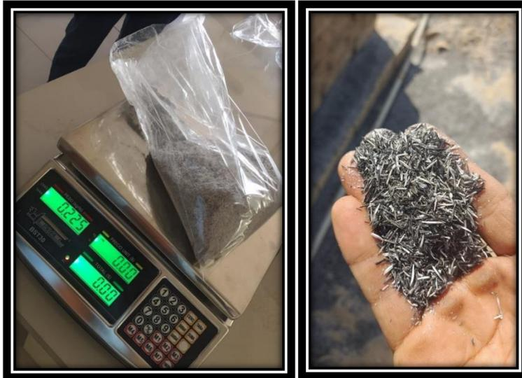
Nota: Podemos Observar en la Grafica el pesado de la ceniza de cascara del arroz, embolsado y el etiquetado con los diferentes porcentajes para luego agregarlos a la mezcla de los bloques de concreto. Elaboración propia.
