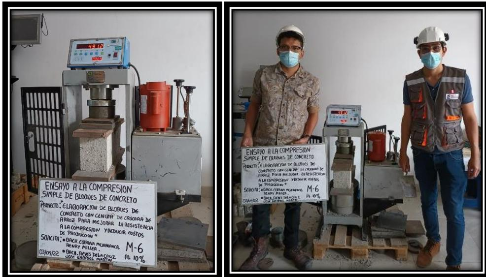
Nota: Observamos en la Grafica los Ensayos de compresión con el tercer grupo de los nuevos bloques de concreto con el 10% de ceniza cascara de arroz. Elaboración Propia.
