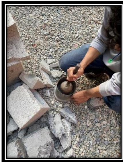
Nota: Observamos en la Grafica como el técnico tritura los nuevos boques de concreto con ceniza de cascara de arroz, para luego realizar el ensayo de densidad con los método de la Fiola y el de la Probeta las respectivamente. Elaboración Propia.
