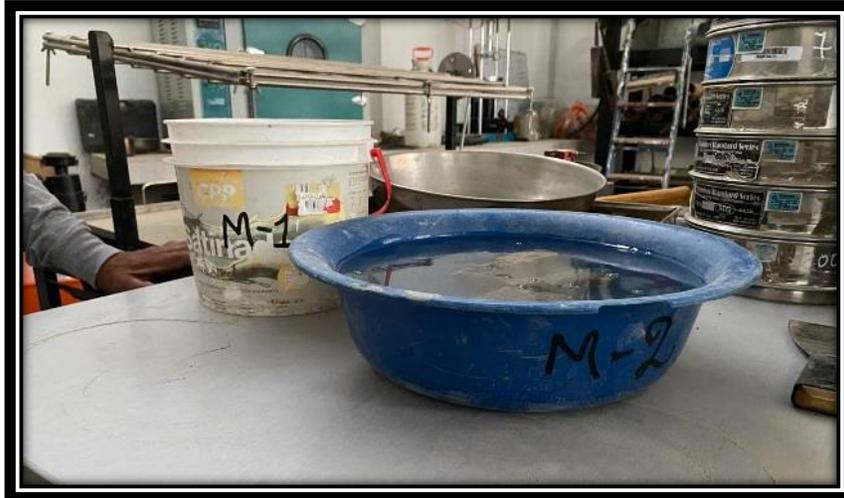
Nota: Podemos Observar en la Grafica el Último ensayo que es el de Absorción, donde sumergiremos en agua. Para luego sacar su Peso Muestra Húmeda menos el Peso Muestra Seca nos darán el resultado de la absorción. Elaboración Propia.
