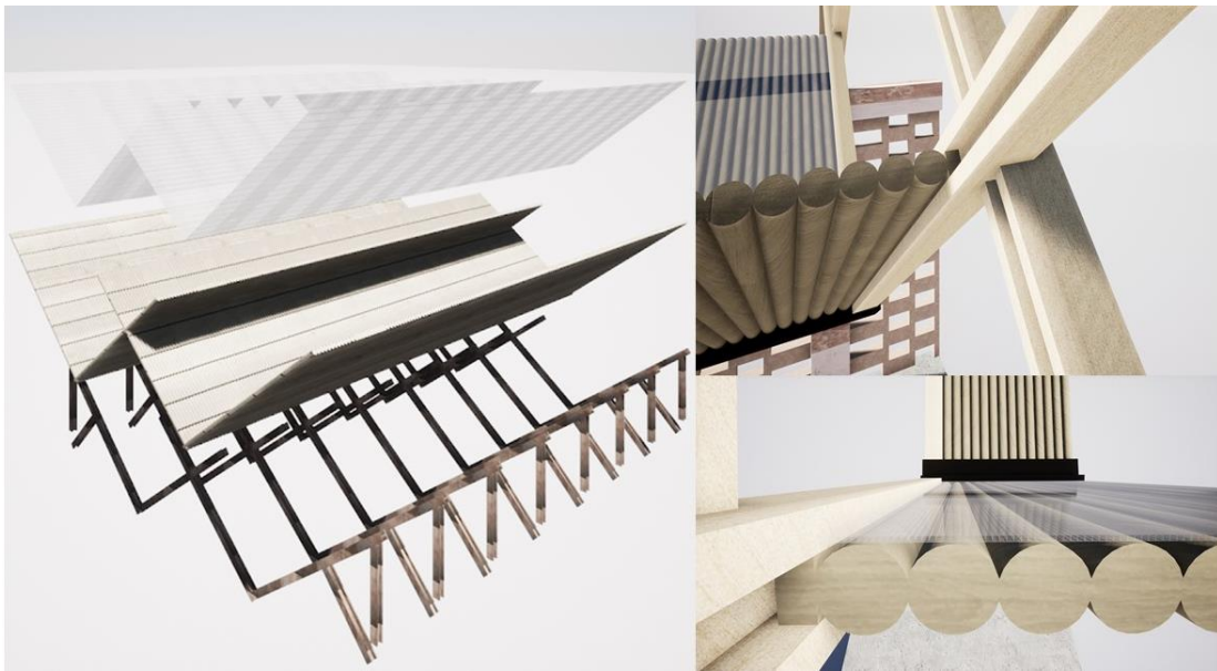
Figura 58: Detalle arquitectónico de cobertura de talleres de centro comunitario.
