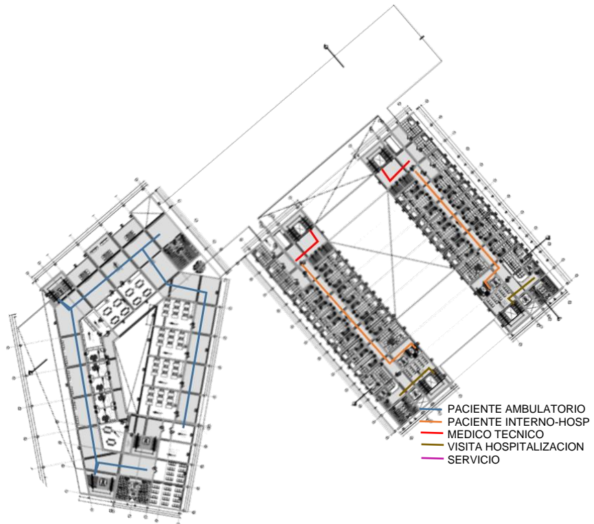
Figura 37 Circulación - Tercer nivel
