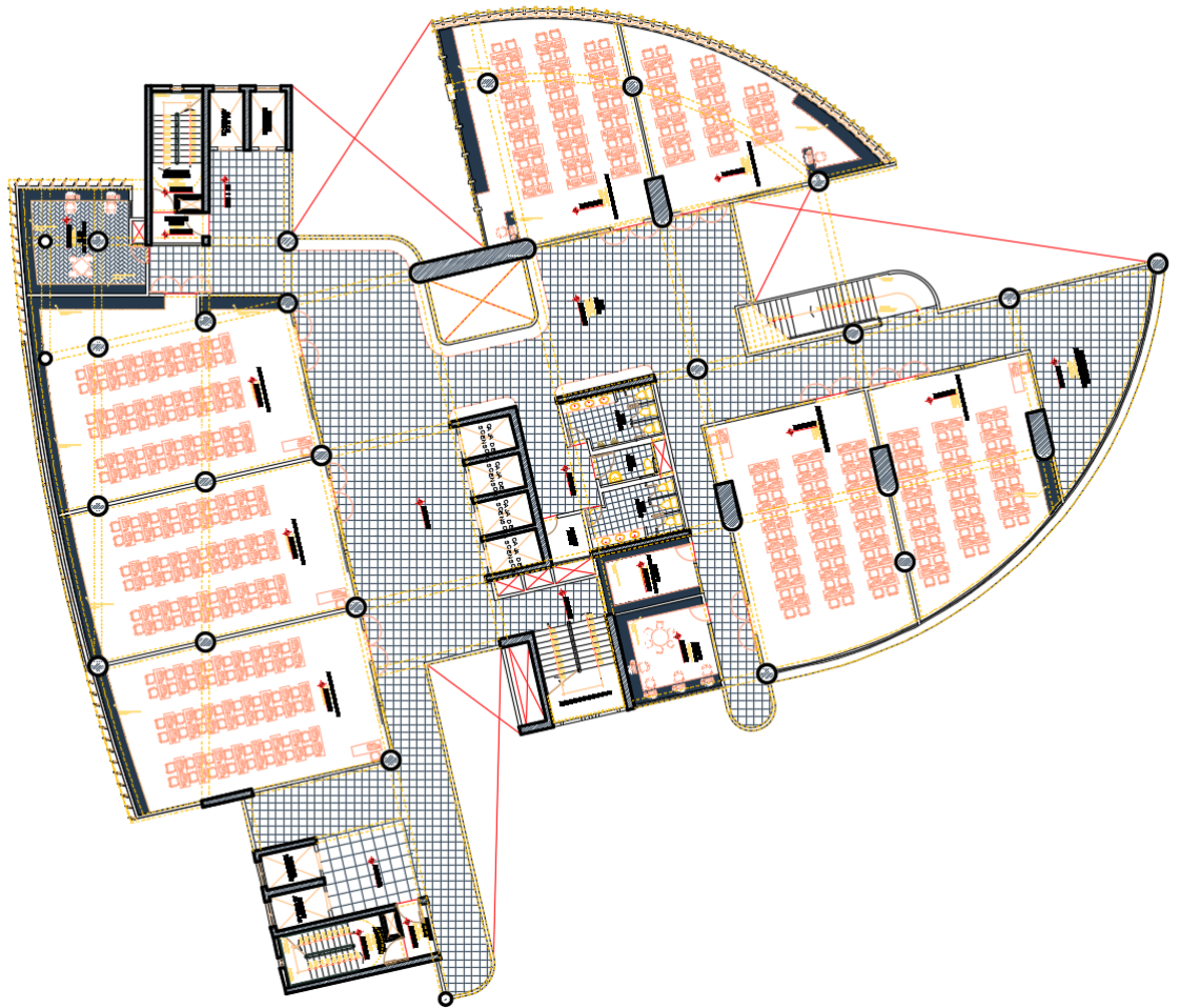
Figura N° 46: PLANO DE DISTRIBUCIÓN 7° PISO / LABORATORIOS DE INFORMÁTICA
