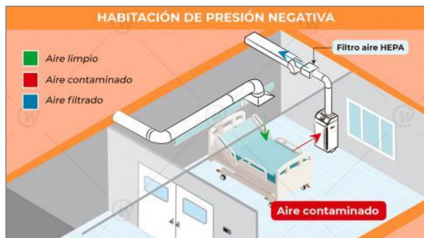
Figura 67. Habitación de presión negativa
