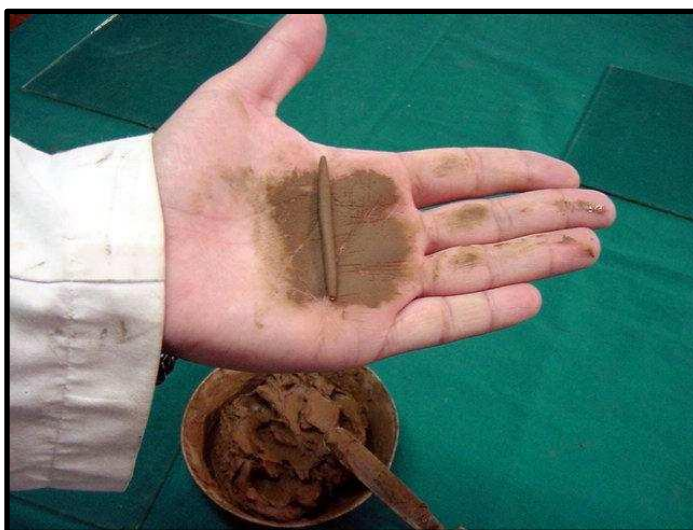
Figura 19. Cilindros de 3 mm en ensayo.
