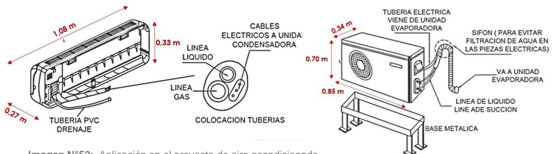
Imagen N°52: Aplicación en el proyecto de aire acondicionado Fuente: Elaboración propia
