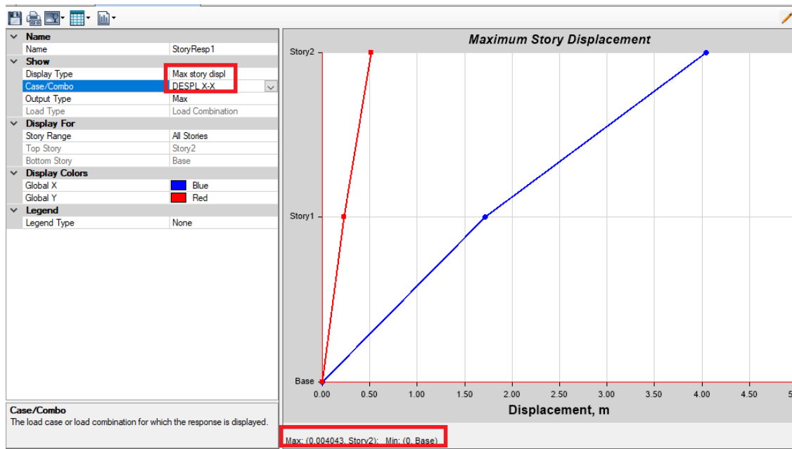
FIGURA N° 97: DESPLAZAMIENTO X-X BLOQUE B
