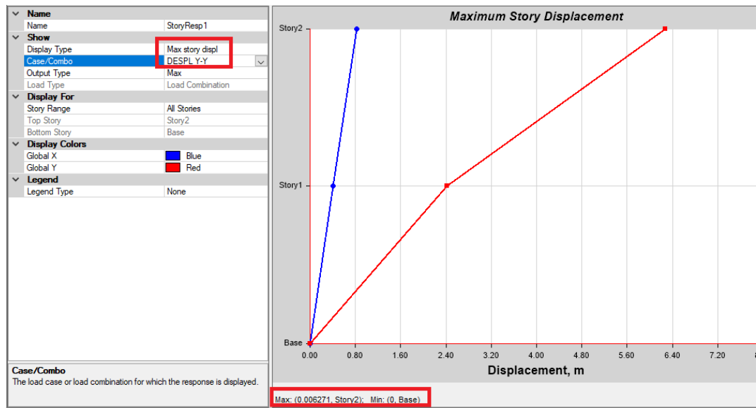
FIGURA N° 104: DESPLAZAMIENTO SENTIDO Y-Y BLOQUE C
