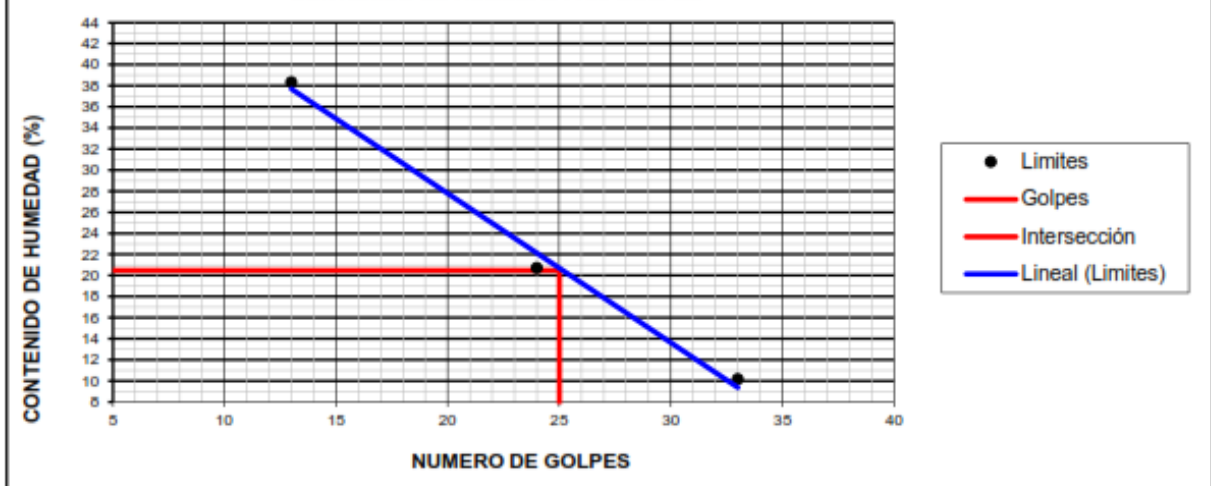
CONTENIDO DE HUMEDAD A 25 GOLPES
