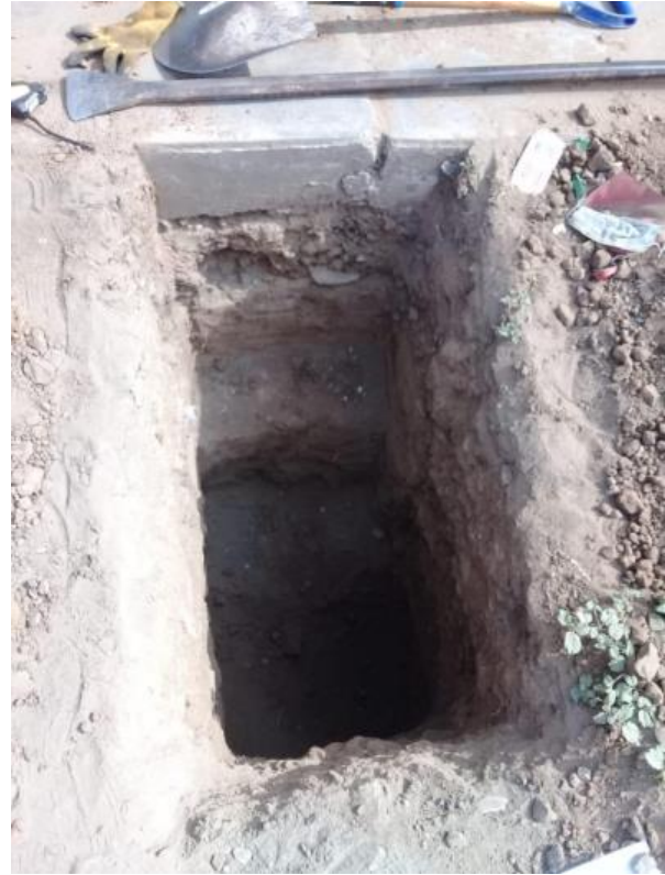
Vista del perfil estratigráfico de la calicata C-2 , nótese en la superficie el material de relleno conformado suelo orgánico, arena y algunas piedras. A continuación, se encontró un estrato de Arenas pobremente graduadas con pocos limos ( SP-SM ), de color beige pardo a amarillo claro, de consistencia media y regular humedad. No se encontró el Nivel de aguas freáticas (NAF).
