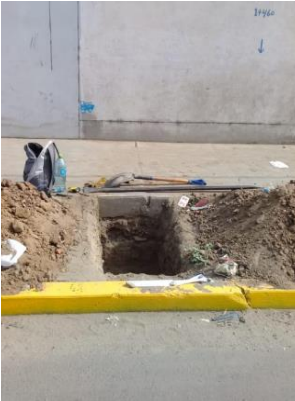
Vista del perfil estratigráfico de la calicata C-2 , nótese en la superficie el material de relleno conformado suelo orgánico, arena y algunas piedras. A continuación, se encontró un estrato de Arenas pobremente graduadas con pocos limos ( SP-SM ), de color beige pardo a amarillo claro, de consistencia media y regular humedad. No se encontró el Nivel de aguas freáticas (NAF).
