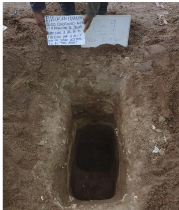
Vista del perfil estratigráfico de la calicata C-9 , nótese en la superficie el material de relleno conformado suelo orgánico, arena y algunas piedras. A continuación, se encontró un estrato de Arenas pobremente graduadas con pocos limos ( SP-SM ), de color beige pardo a amarillo claro, de consistencia media y regular humedad. No se encontró el Nivel de aguas freáticas (NAF).
