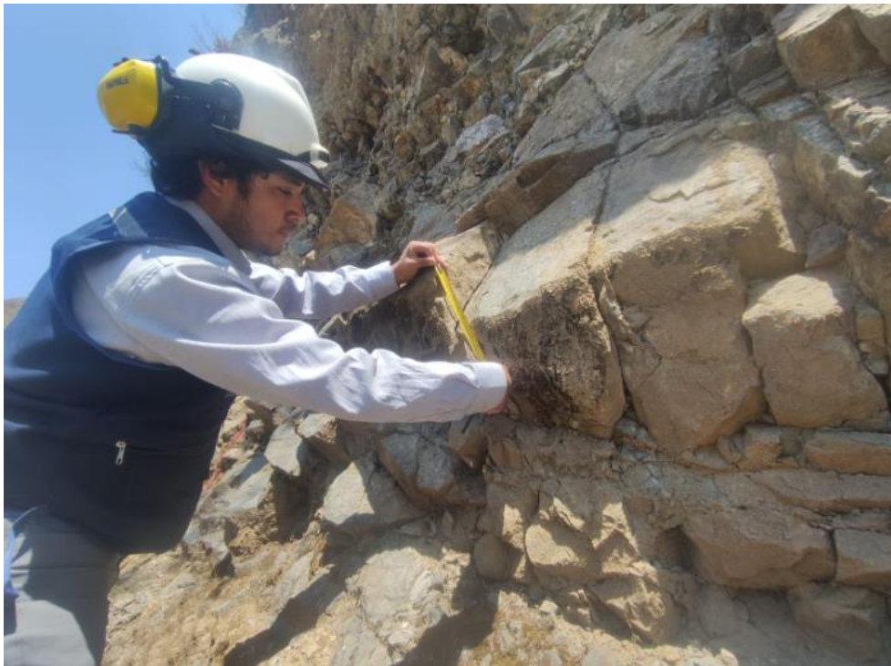
Figura 48 Toma de medidas de abertura
