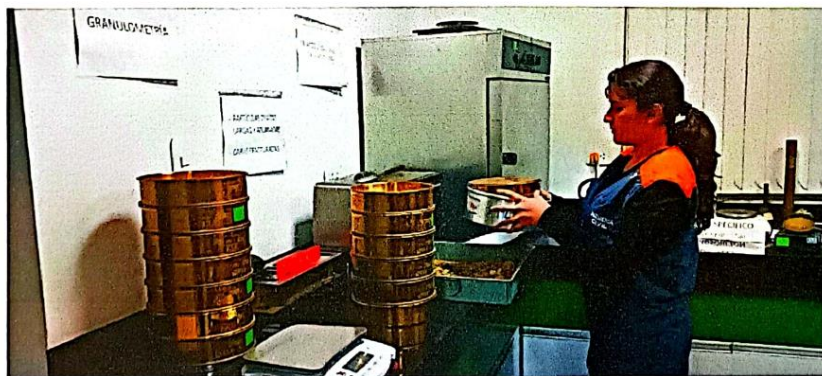
Figura N° 24: Ensayo de granulometría del material extraído de las canteras mencionadas
