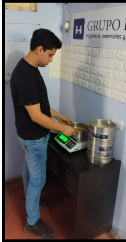
Foto 14. Ensayo de granulometría
