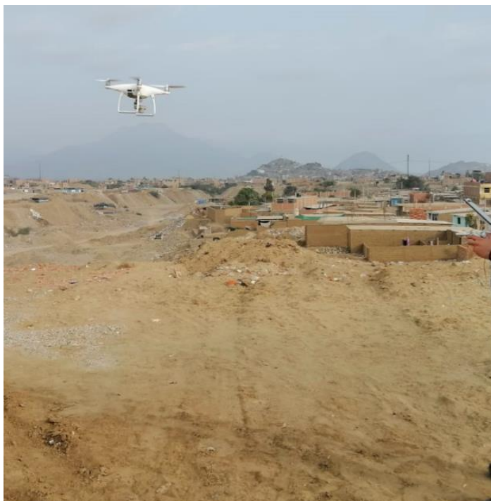
Foto 7. Levantamiento topográfico con dron
