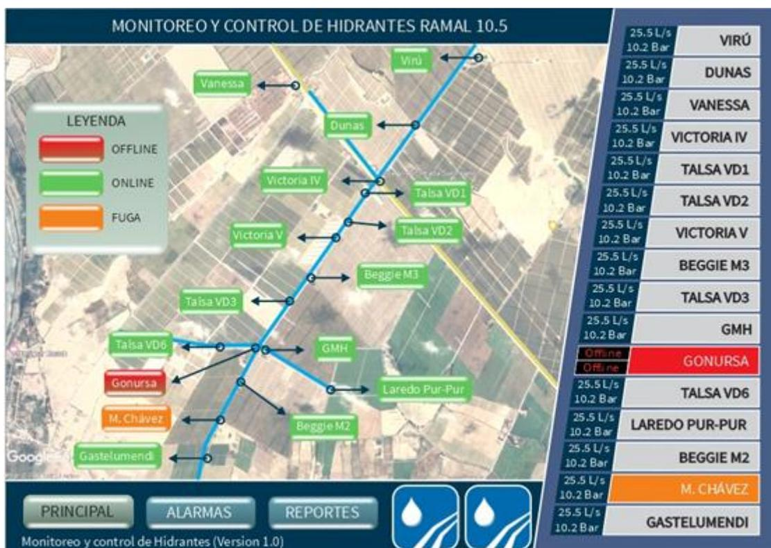
En la figura 20 se muestra el monitoreo y control de hidrantes del ramal 10.5 en la que se observa el volumen total por día, el caudal, la presión, las alarmas y reportes para los usuarios de VIRÚ, DUNAS, VANESSA, VICTORIA IV, TALSA VD1, TALSA VD2, VICTORIA V, BEGGIE M3, TALSA VD3, GMH, GONURSA, TALSA VD6, LAREDO PUR-PUR, BEGGIE M2, M. CHAVEZ, GASTELUMENDI
