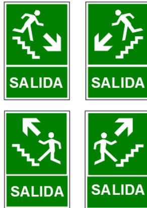
Figura 131: Señales de evacuación en escaleras
