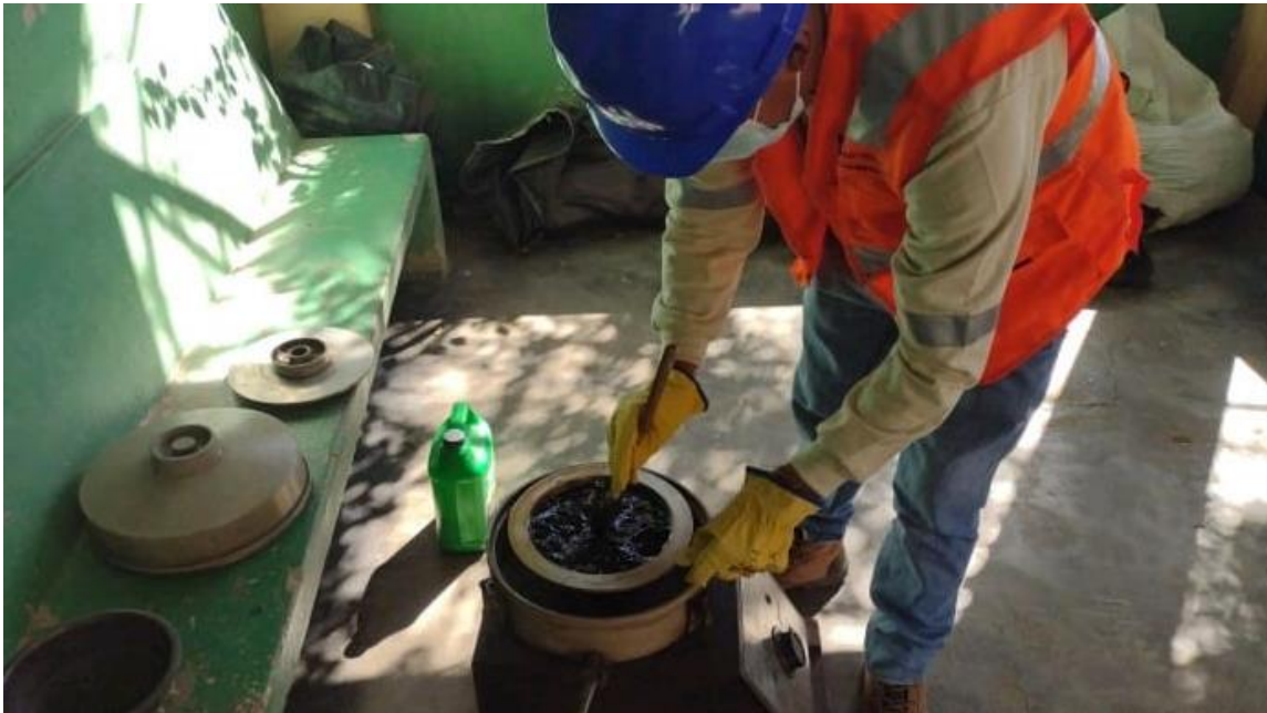
Imagen N°48: Vistas del ensayo de lavado asfáltico del material de base estabilizada, el cual permite obtener el residuo asfáltico total de la mezcla bituminosa.
