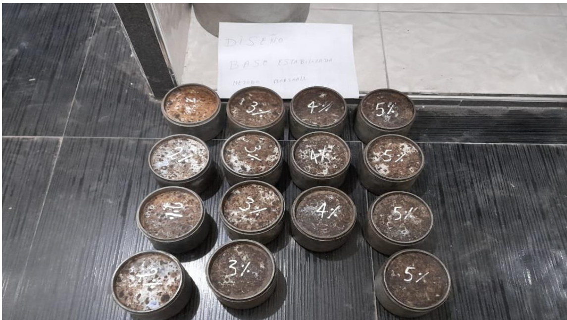
Imagen N°46: Ensayo de diseño de mezcla de la base estabilizada realizada para el proyecto, moldeo de probetas con diferente cantidad de emulsión asfáltica.
