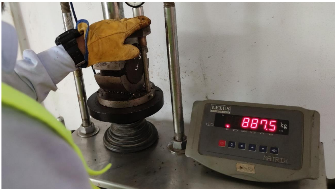
Imagen N°02: Ensayo de estabilidad de Base reciclada estabilizada
