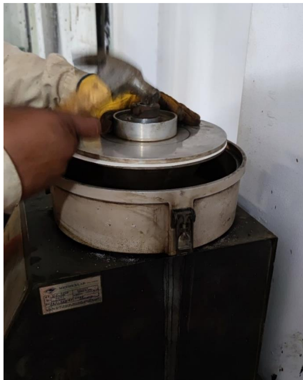
Imagen N°34: Ensayo de contenido de asfalto de base estabilizada.
