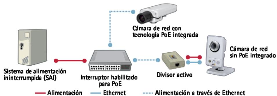
Figura 9: Alimentación a través de Ethernet.
