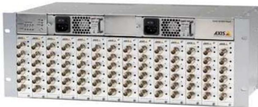
Figura 15: Servidor de video en rack.
