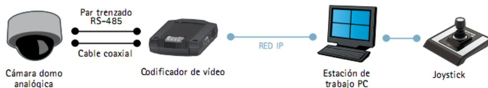
Figura 16: Conexión Cámaras.
