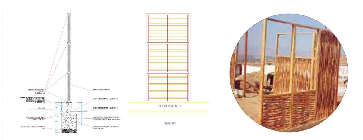
Imagen N° 116: detalle de muro de quincha mejorada para el proyecto
