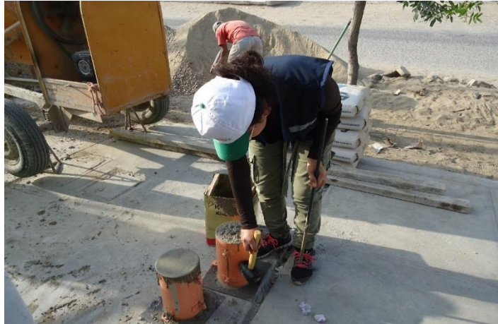
Figura 39 - Martillando la probeta.
