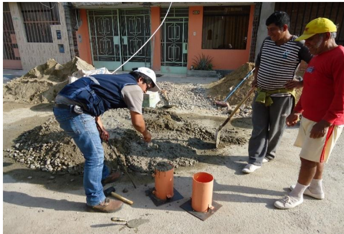
Figura 40 - Compactando la mezcla.
