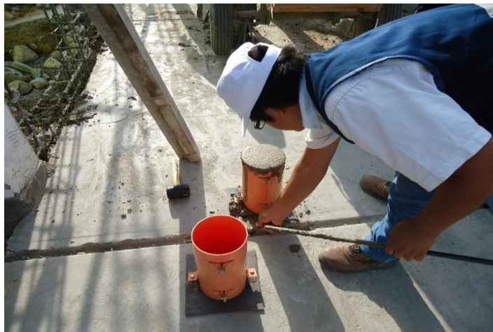
Figura 37 - Llenado de probetas.
