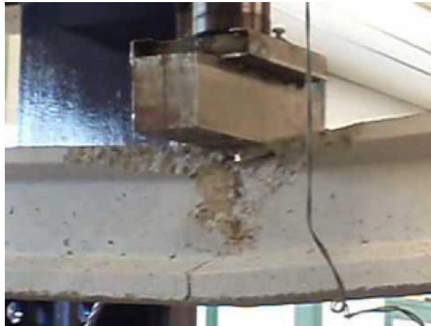
Figura 63- Falla satisfactoria por flexión de una viga de concreto.
