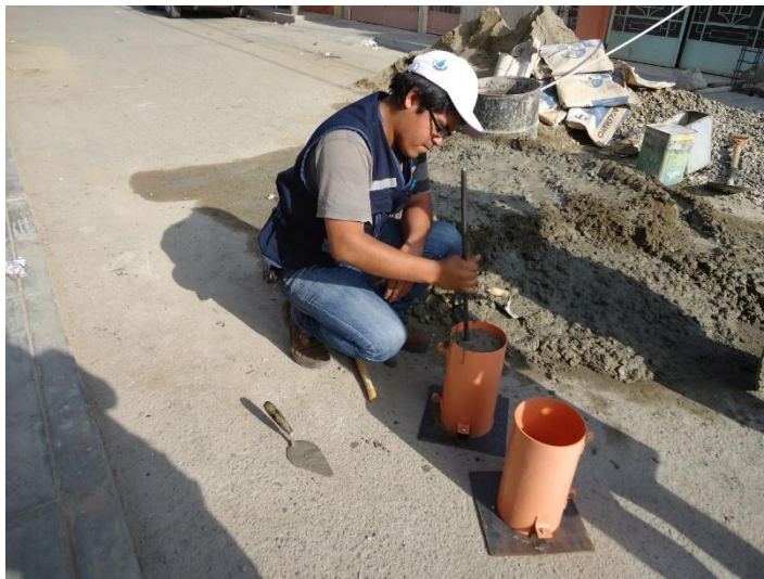
Figura 40 - Compactando la mezcla.
