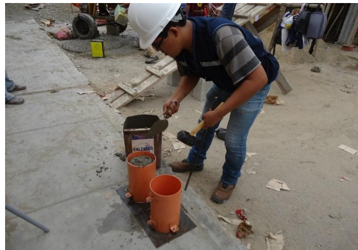
Figura 43 - Terminando de llenar la probeta.
