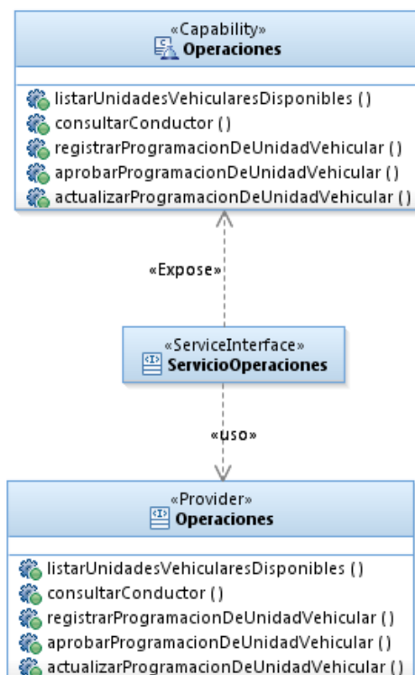
Figura N° 52 - Interfaz de servicios de la capacidad Operaciones
