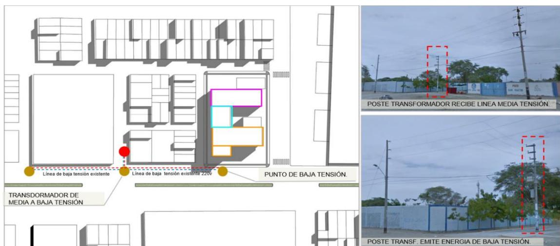
Nota. Se observa la ubicación de un transformador, el cual reparte energía de baja tensión a los alrededores del terreno. Elaboración propia.
