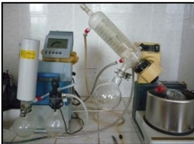
**Fotografía 4.-** Concentración del extracto etanólico en un equipo de rotavapor a una temperatura de 40 °C.
