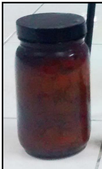
**Fotografía 2.-** En un recipiente de boca ancha se cubrirá con etanol de 80°, se dejará en reposo y en ausencia de luz.
