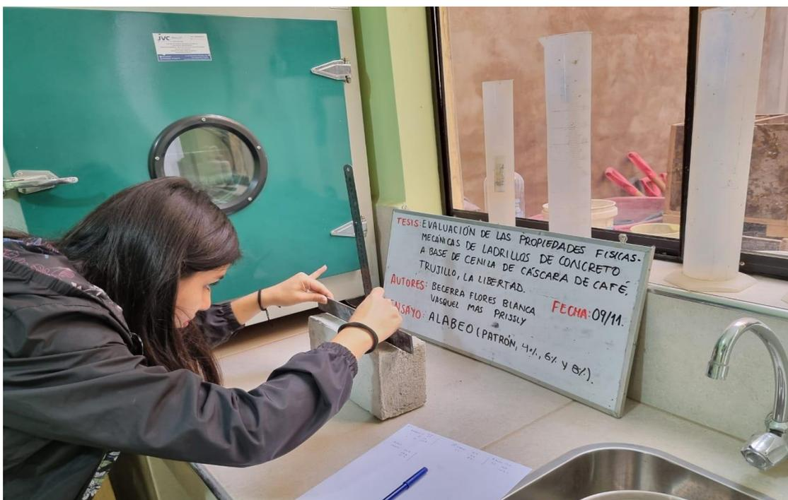
*Ensayo de alabeo en ladrillos.*
