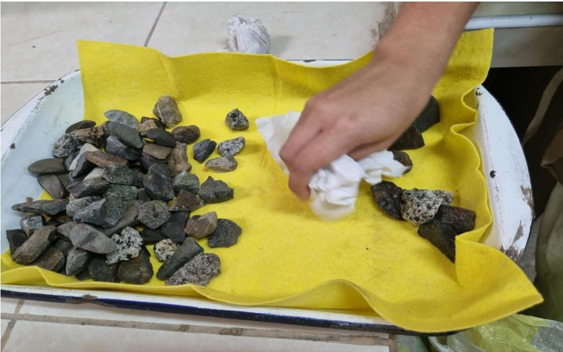
*Ensayo de absorción de confitillo.*
