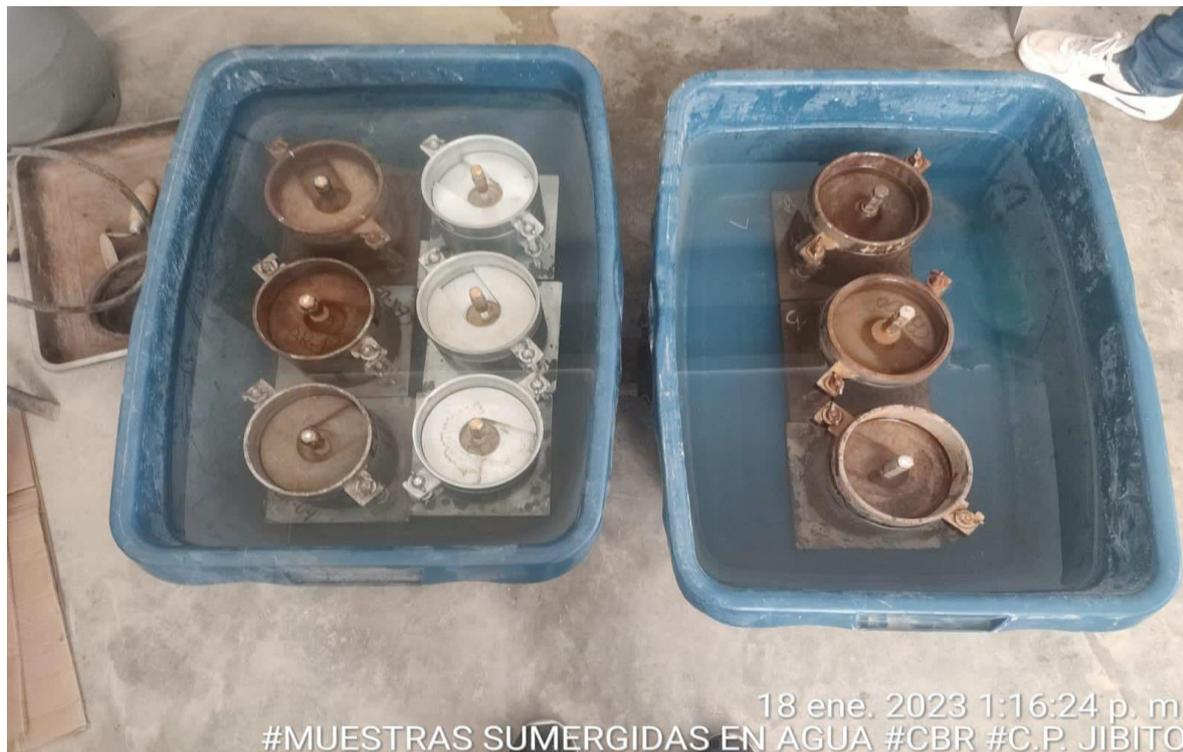
*Nota:* Moldes sumergidos en agua del Ensayo de CBR.
