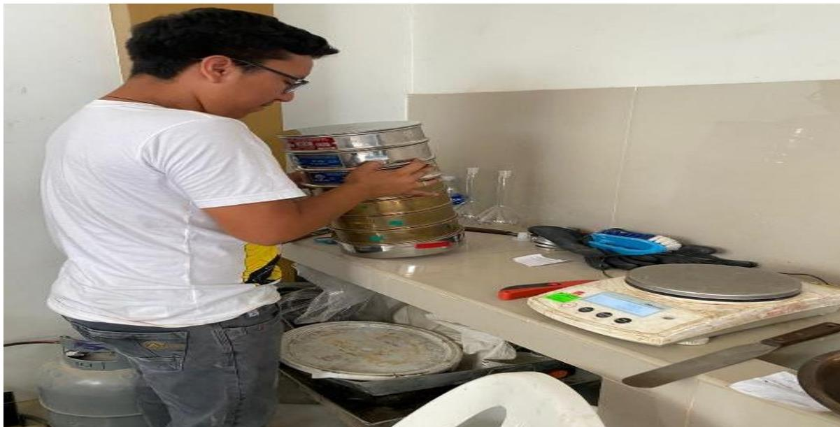
*Nota:* En la siguiente figura se observa la colocación de la muestra y empezar el proceso de tamizado (Análisis Granulométrico)
