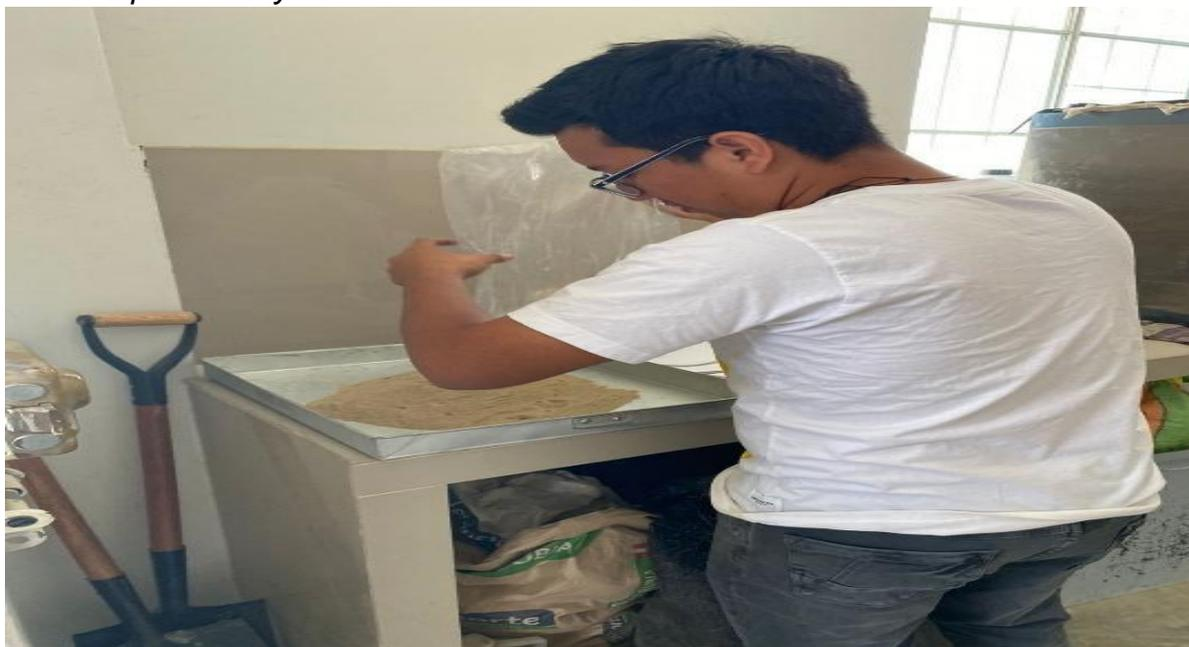
*Nota:* En la siguiente figura se observa la toma de muestra para el ensayo del Proctor Modificado.
