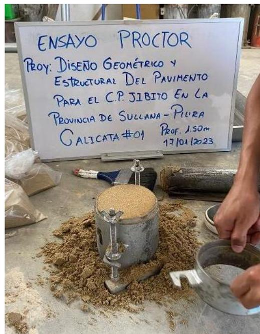
*Nota:* Muestra después del ensayo de Proctor Modificado
