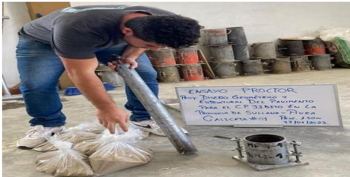
*Nota:* En la siguiente figura se observa la toma de muestra para el ensayo del Proctor Modificado.
