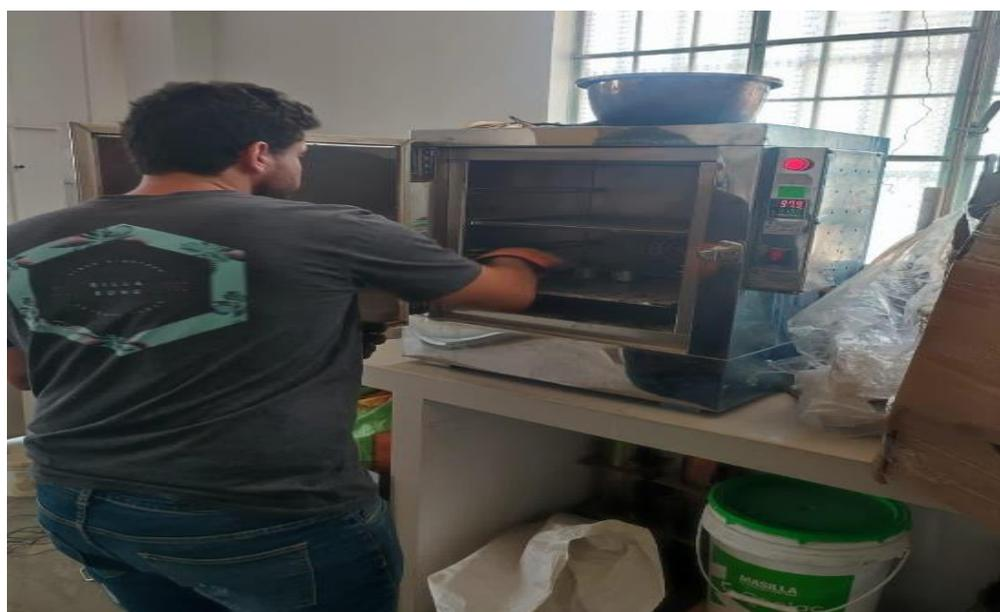
*Nota: Se observa las muestras en el horno para el ensayo de Contenido de humedad.*
