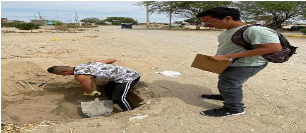
*Nota:* Excavación de la Calicata a cielo abierto, a una profundidad de 1.50 m, en la Transversal Brasil con Calle Argentina
