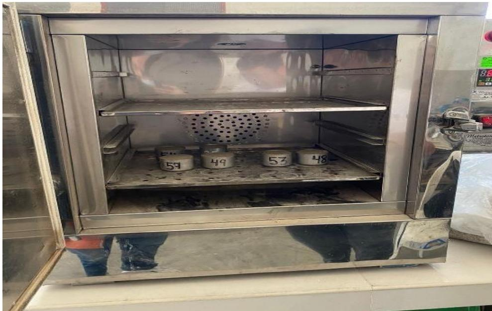
*Nota: Se observa las muestras en el horno para el ensayo de Contenido de humedad.*
