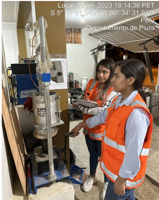
Foto 10. Elaboración de ensayo CBR
