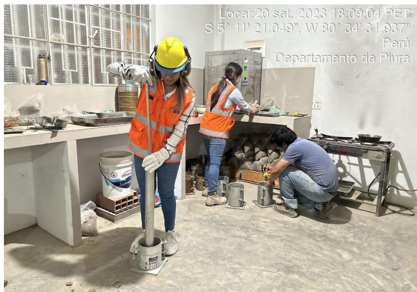
Foto 9. Elaboración de ensayo de Proctor
