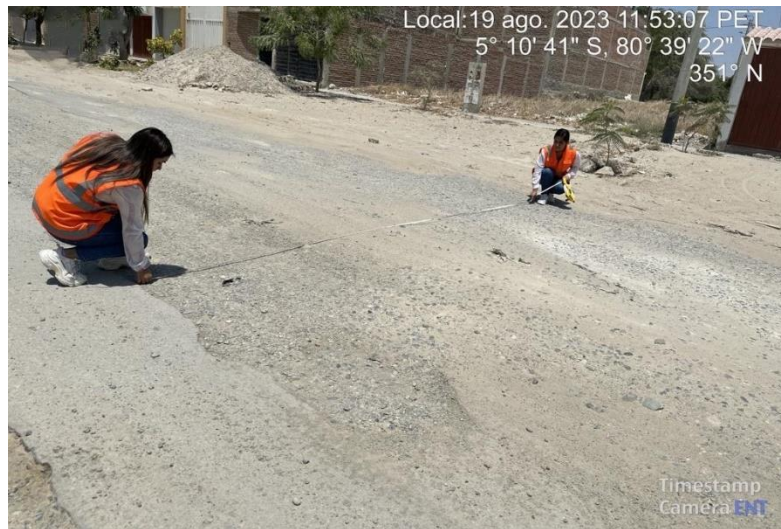
Foto 17. Toma de medidas de fallas existentes en nuestra área de estudio
