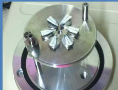
Colocación de las muestras en el equipo de metalización.
