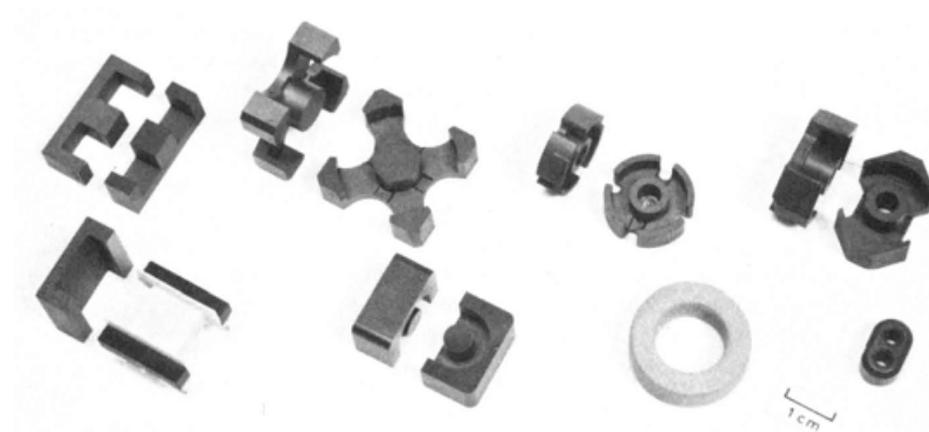
**Fig.3.5: Algunos Núcleos de ferrita de transformadores de baja potencia**
