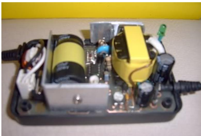
**Figura 5-1: Fuente Conmutada SMPS implementada**
