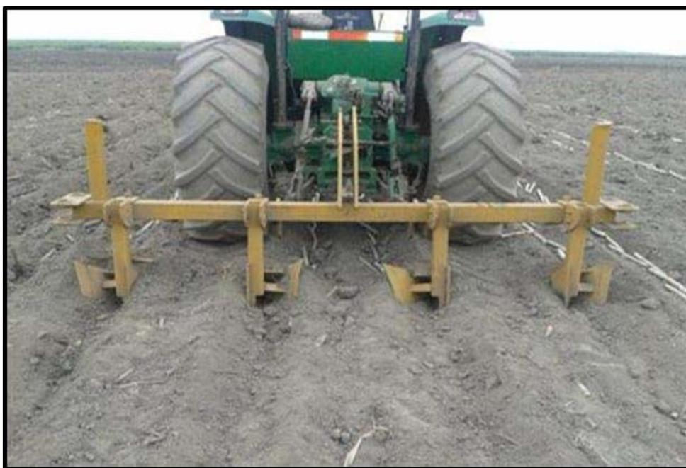
*FIG.36 Tapado de semilla de caña con máquina.*
