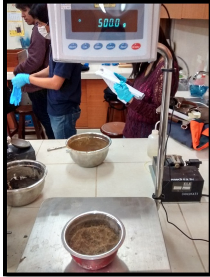
Ilustración 9. Granulometría de los agregados
