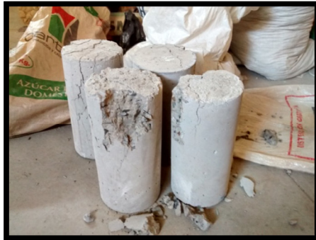
Ilustración 16. Estados de las probetas después de las roturas.
