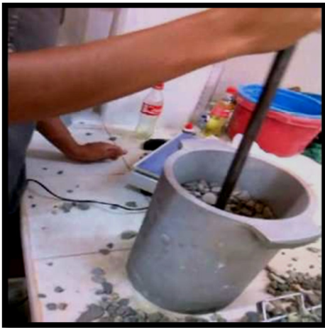
Ilustración 10. Peso unitario suelto y compactado
