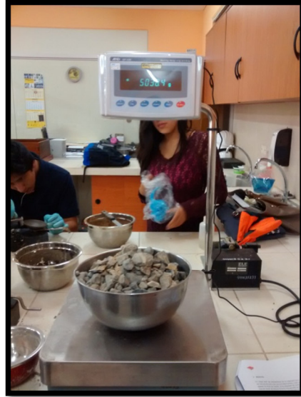
Ilustración 9. Granulometría de los agregados
