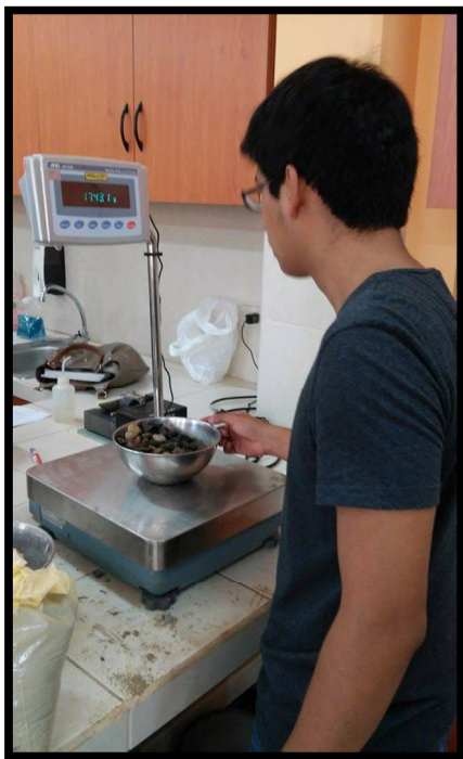
Ilustración 11. Gravedad Específica y absorción de agregados
