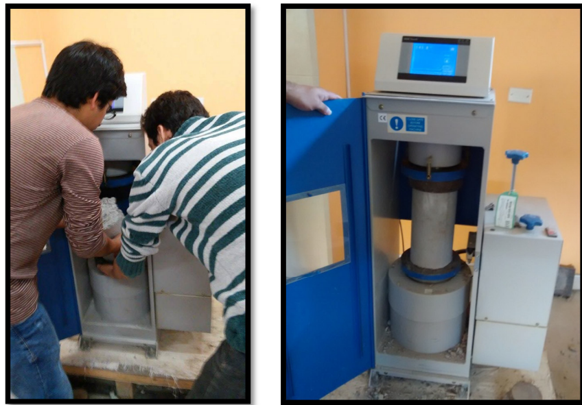
Ilustración 15. Ensayo a la compresión de probetas
