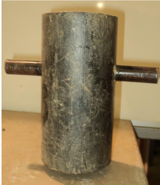
Figura 3: Detalle de martillo de golpe de equipo de sondaje DPL
