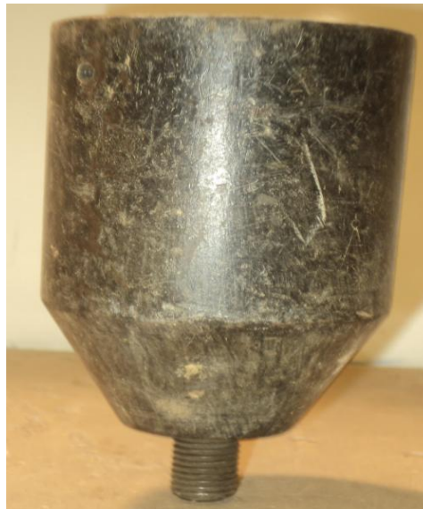
Figura 4: Detalle de la cabeza de golpeo o yunque de equipo de sondaje DPL
