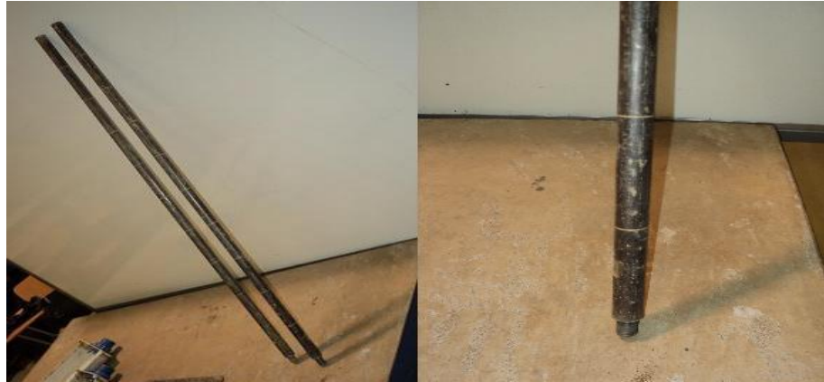
Figura 5: Detalle de varillas de traspaso de carga de equipo de sondaje DPL
