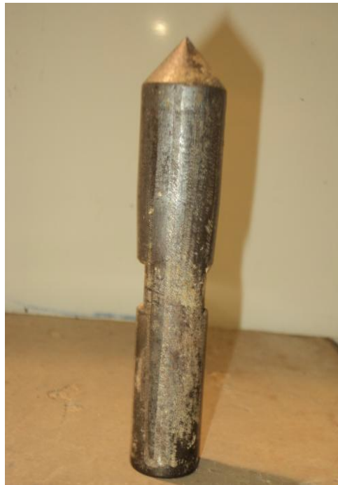
Figura 2: Detalle de cono dinámico de equipo de sondaje DPL
