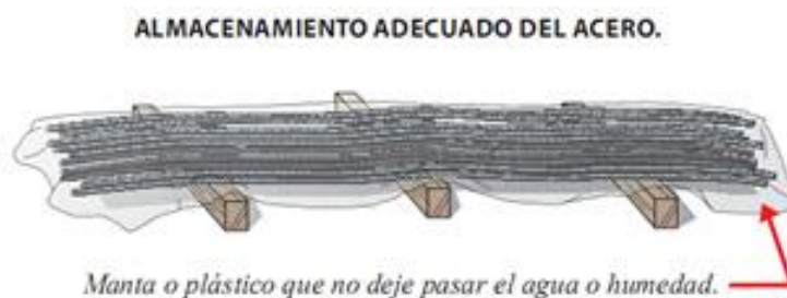
IMAGEN Nº 01: Almacenamiento Adecuado del Acero
