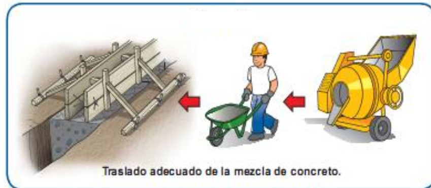
IMAGEN Nº 3: Correcto Traslado de Concreto
