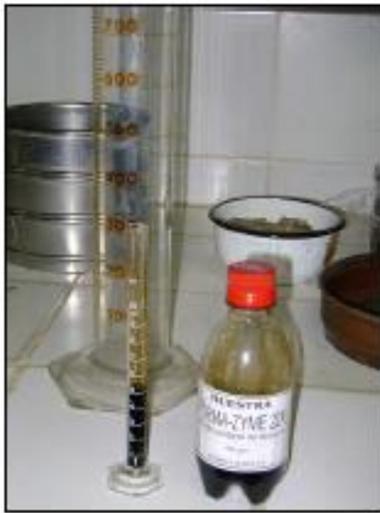
Foto 3: Medición del aditivo conaid al material.
