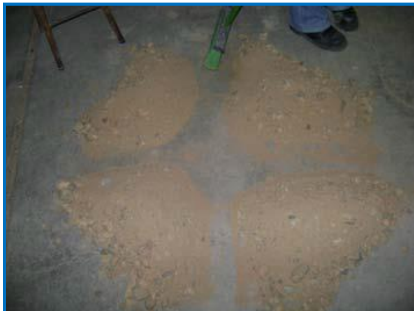
Foto 5: Cuarteado del material para realizar el tamizado
