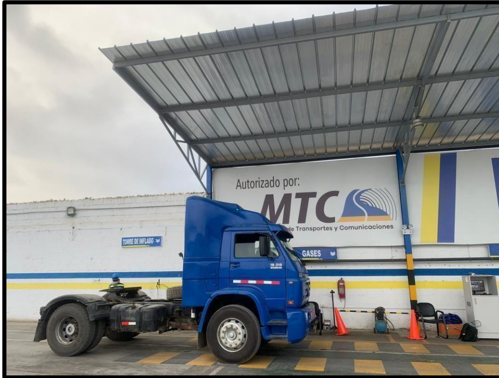
Ilustración 17. Vehículo pasa inspección visual y continuara por la prueba de emisiones de gasolina (gases)
