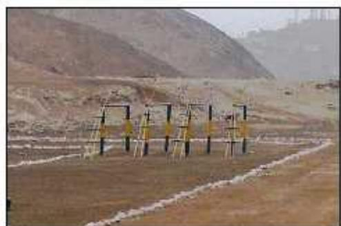
**8.- Pilotes:** Una fosa de 4 m de ancho por 5 m de largo, con troncos de 35 cm de alto, colocados a 80 cm de separación.
