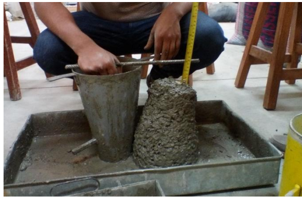
Ilustración 12: Asentamiento 3.5" Diseño Correcto
