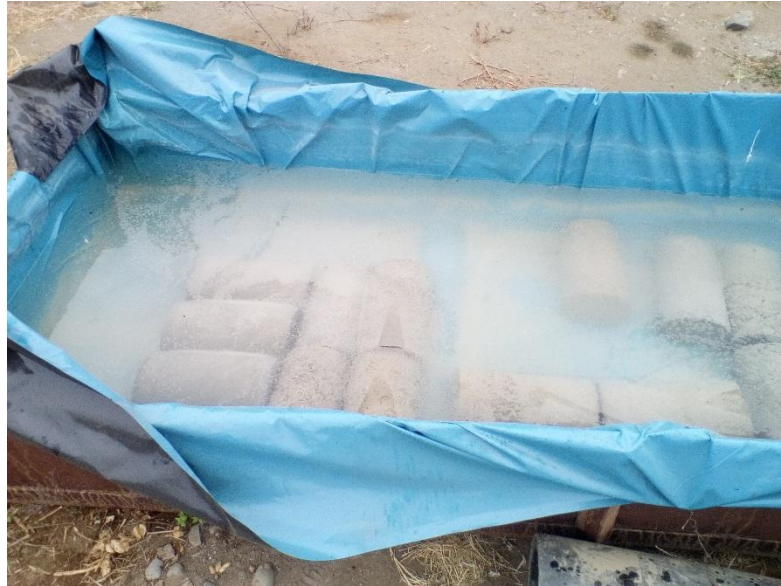
Curado de los testigos cilíndricos
