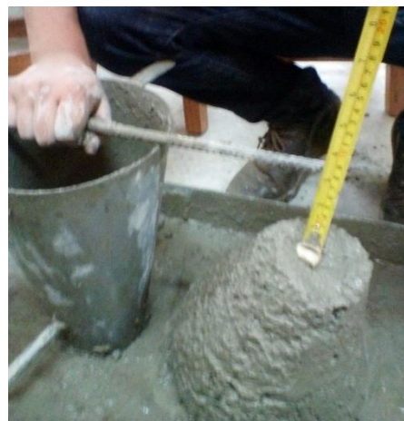
Ilustración 7: Asentamiento 3.1" Diseño Correcto
