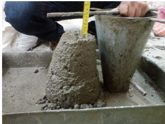
Ilustración 9: Asentamiento 3" Diseño correcto
