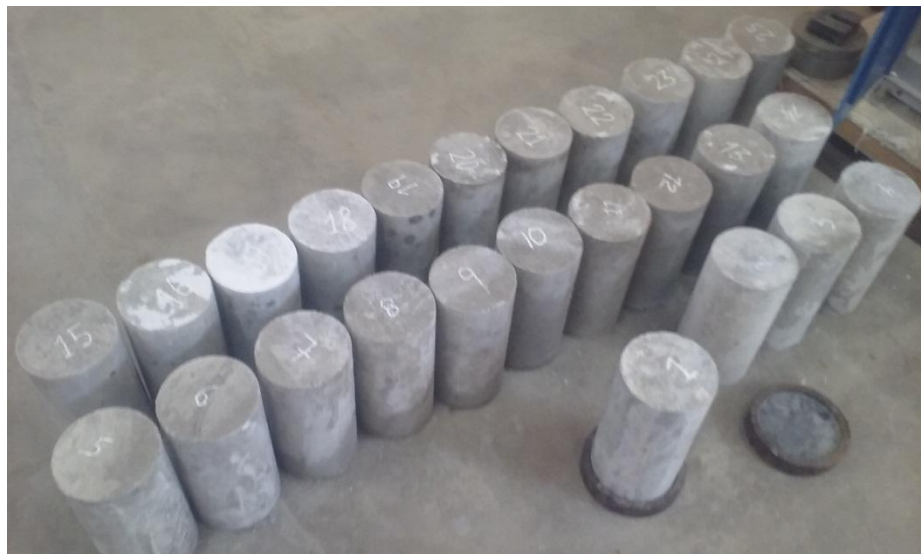
Testigos cilíndricos a punto de ser ensayados
