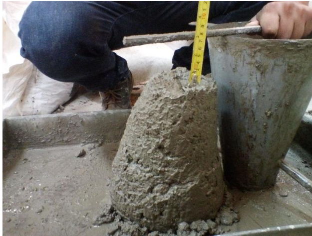
Ilustración 14: Asentamiento 3" Diseño Correcto
