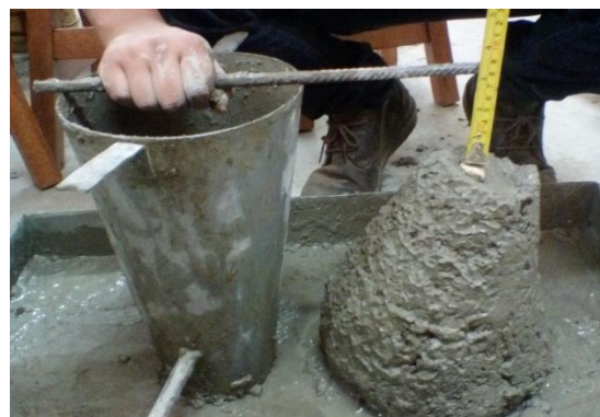
Ilustración 13: Asentamiento 3.5" Diseño Correcto
