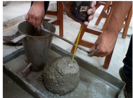
Ilustración 3: Diseño por Asentamiento Correcto
