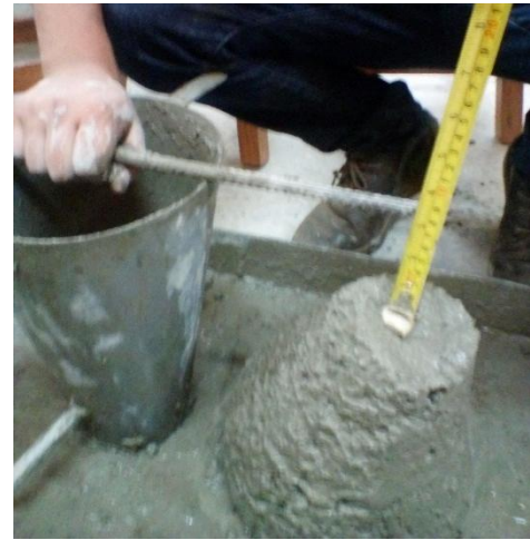
Ilustración 5: Asentamiento 3.5" diseño correcto
