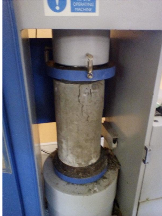
Ensayo de los testigos cilíndricos
