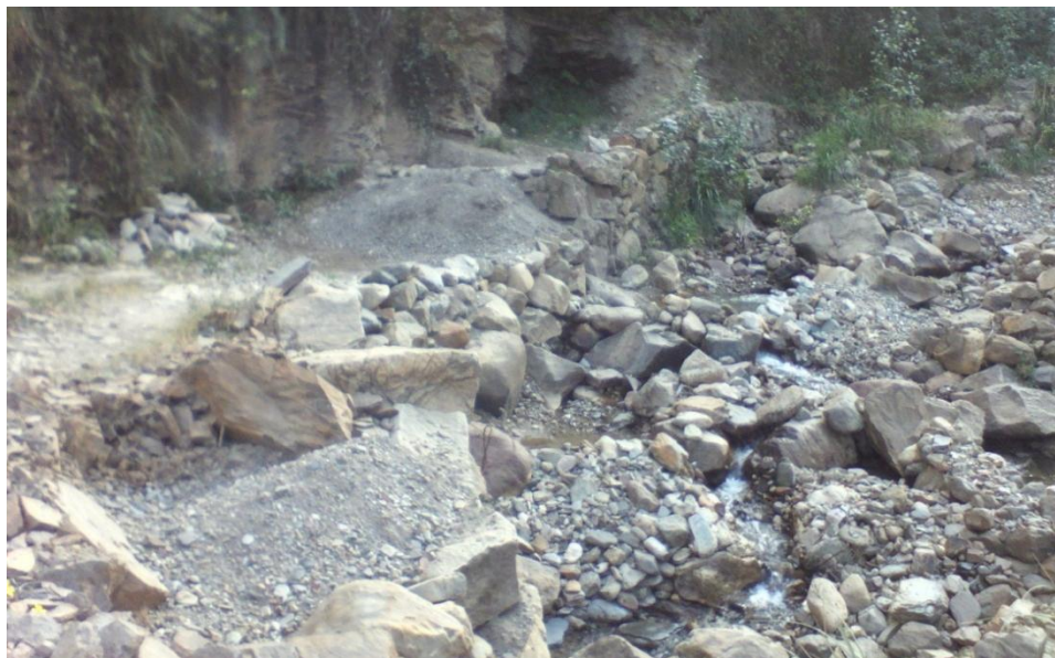
Acopio del Hormigón al Margen del Río Canchan, extraído manualmente.
