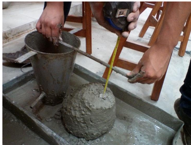
Ilustración 6: Diseño por Asentamiento Incorrecto
