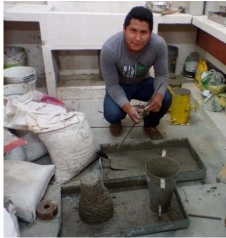
Ilustración 11: Asentamiento 3.5" Diseño Correcto
