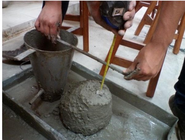
Ilustración 8: Diseño por Asentamiento Incorrecto
