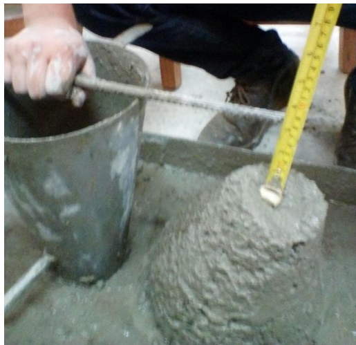
Ilustración 10: Asentamiento 3.8" Diseño Correcto
