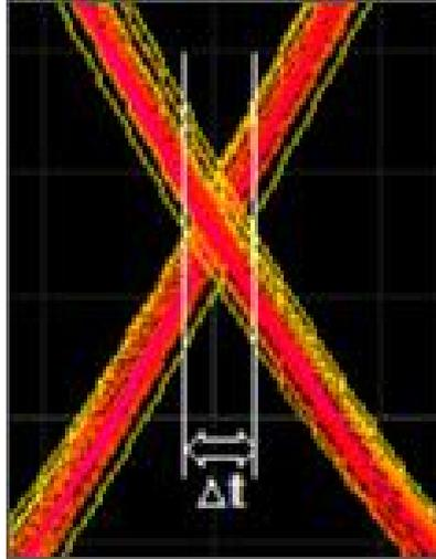
**Figura 3.4.** Medición de Jitter
