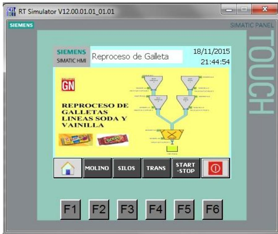
Figura N°6.17: Simulación de la Pantalla Principal
