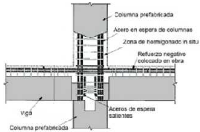
Figura 63: Detalle unión columna prefabricada - viga solera
