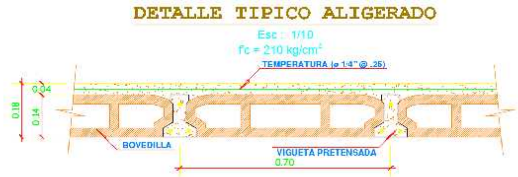
Figura 24: Detalle de losa aligerada con viguetas prefabricadas
