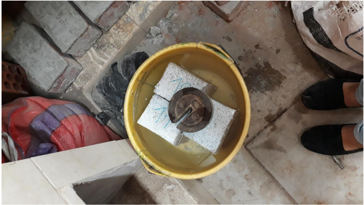
Figura 51. Unidades papel - agua sumergidas 24 horas
