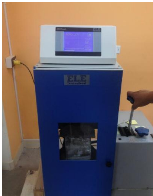
Figura 11. Máquina de compresión ELE International ADR Touch Head
