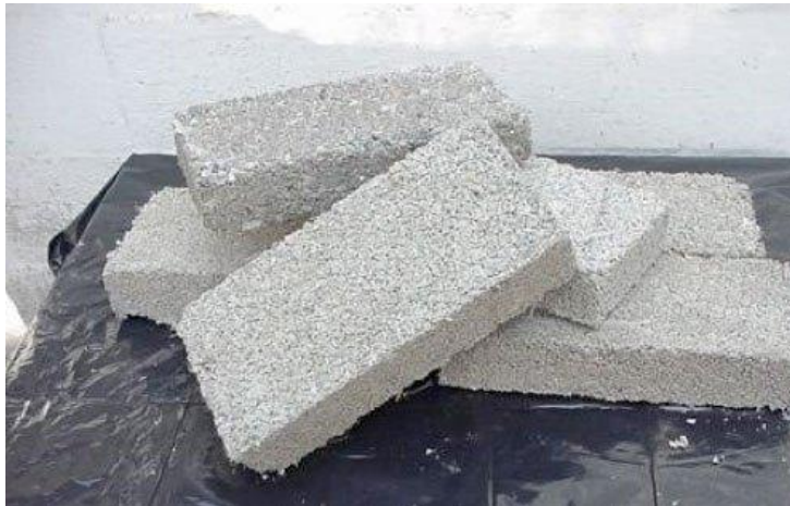
Figura 22. Ladrillo de Plástico usado y cáscaras de cacahuate
