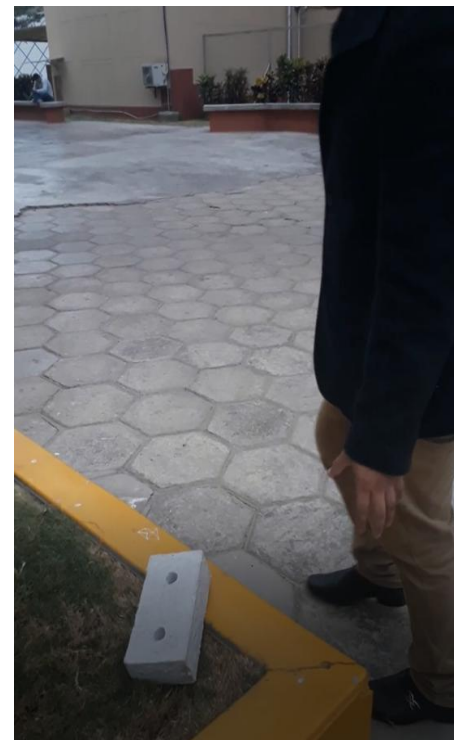
Figura 60. Caída del ecoladrillo sin registro de daños
