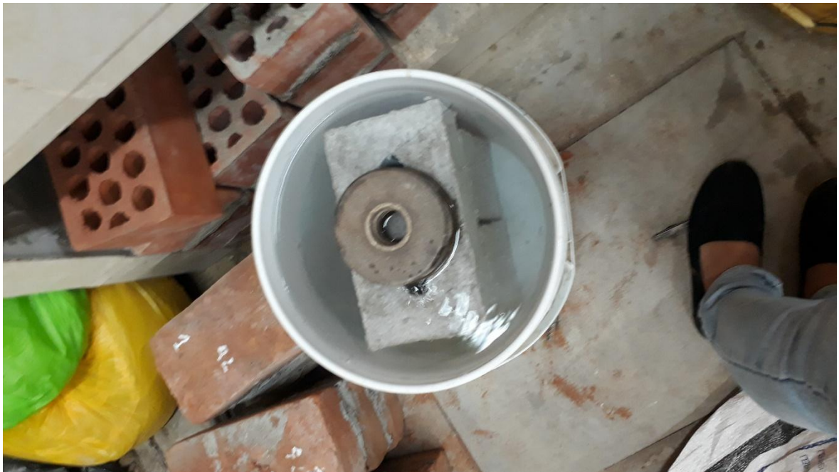
Figura 52. Unidades cemento - papel - agua sumergidas 24 horas
