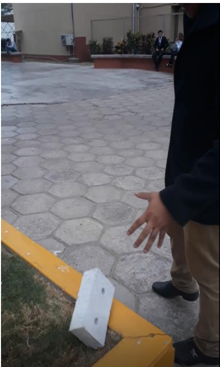
Figura 60. Caída del ecoladrillo sin registro de daños
