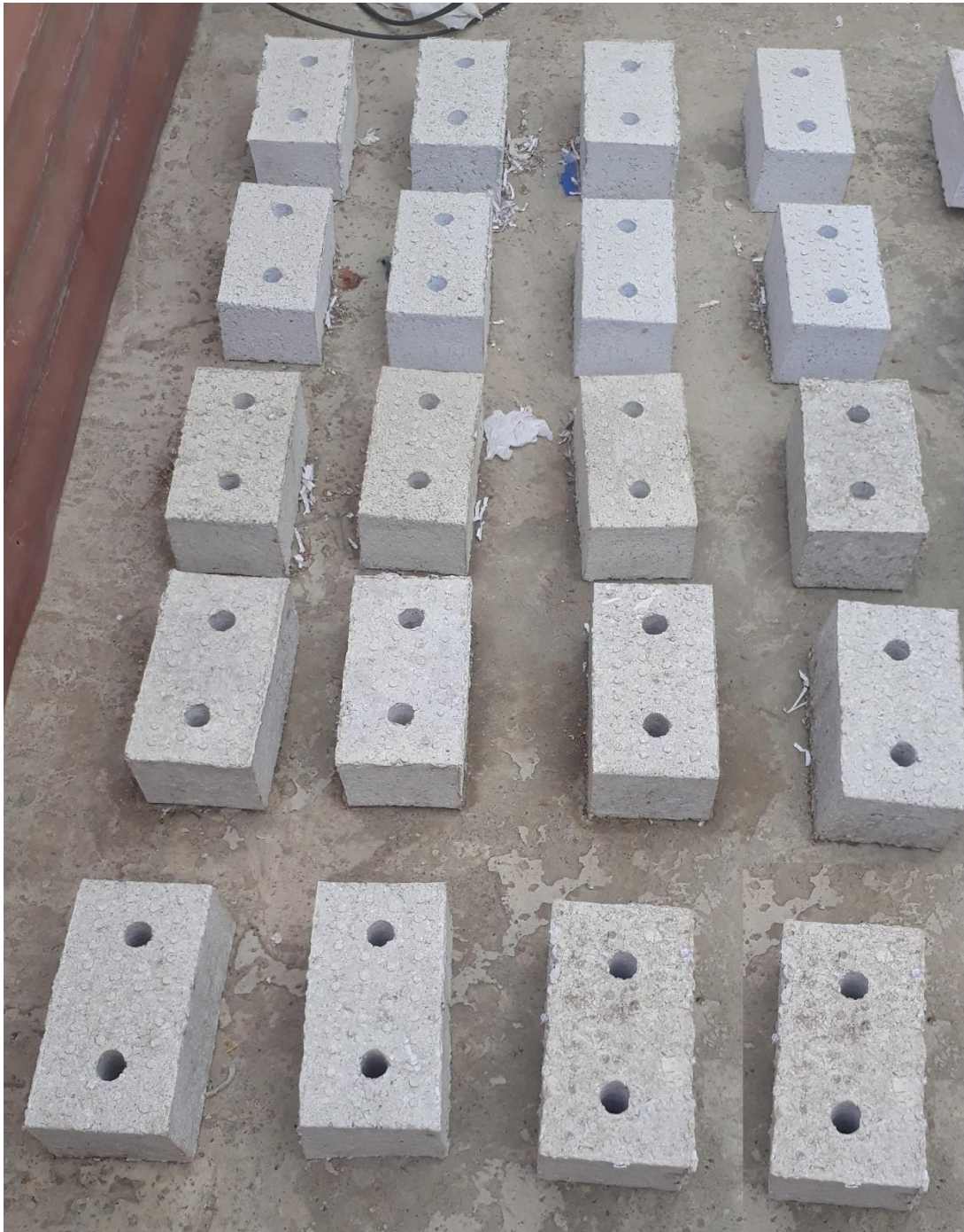
Figura 47. Ladrillos de Cemento - Papel – Agua a aire libre
