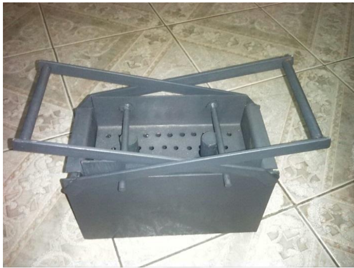
Figura 30. Prensadora de Papel
