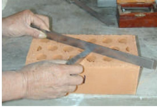
Figura 9. Ensayo de Alabeo
