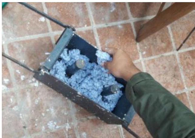
Figura 41. Colocación de la masa dentro de la Prensadora de papel
