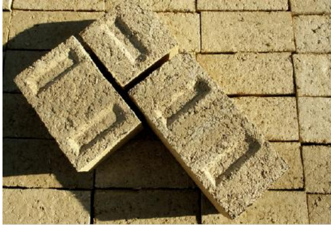
Figura 21. Ladrillo de Cáñamo y paja
