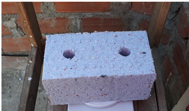
Figura 31. Ladrillo hecho por la Prensadora de Papel
