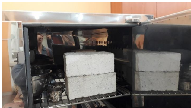
Figura 50. Unidades Colocadas en horno
