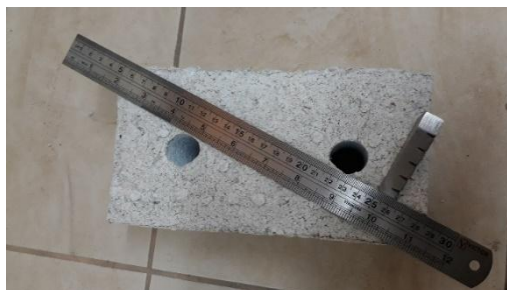
Figura 49. Ensayo de Alabeo
