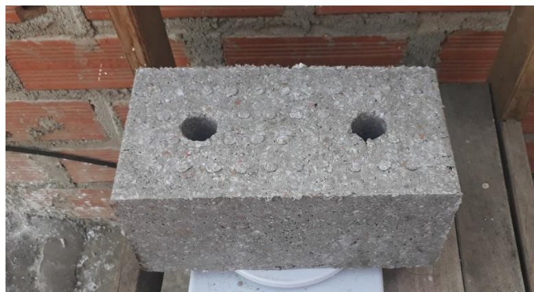
Figura 46. Ecoladrillo con un diseño de mezclas de Cemento - Papel - Agua
