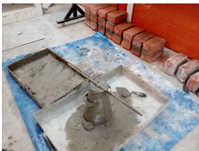
Figura 6: diseño por rendimiento incorrecto (Fuente propia)
