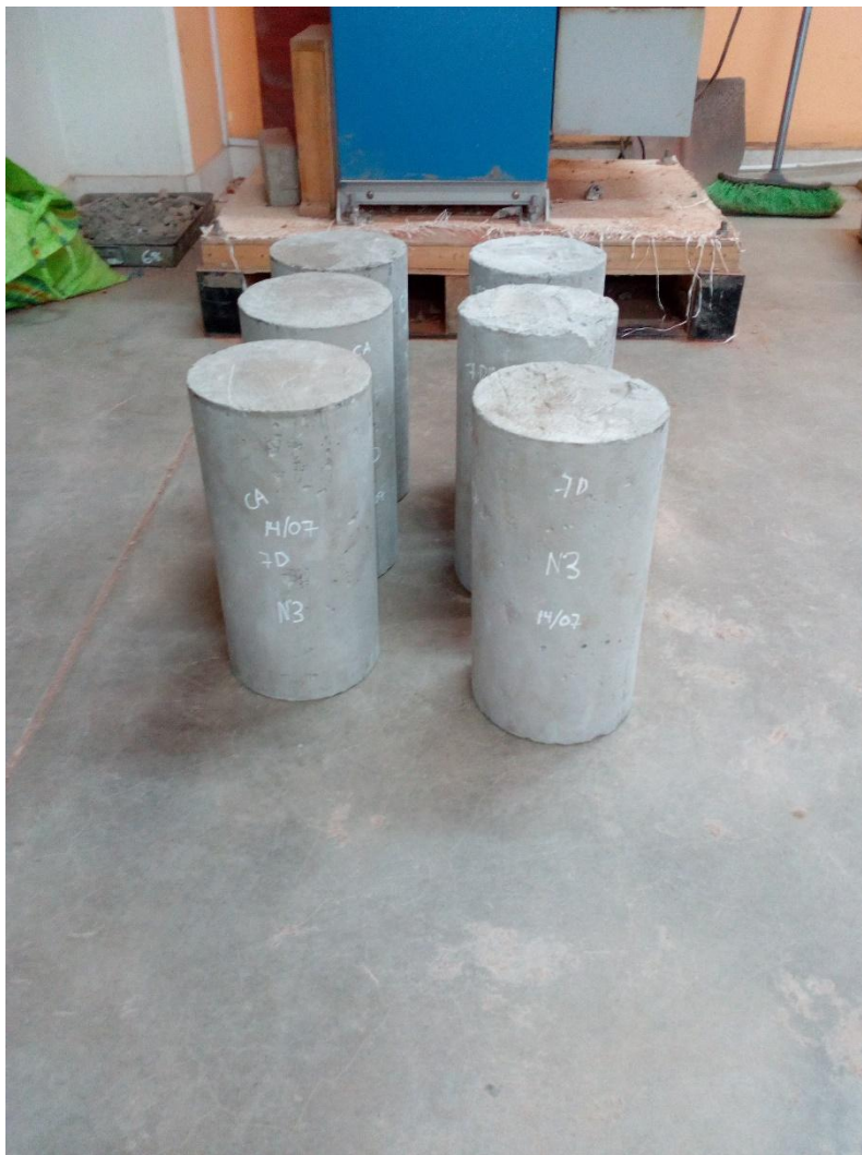
Probetas con y sin aditivo chema3 según las (NTP)
