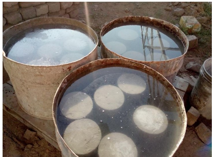
Curado de testigos cilíndricos
