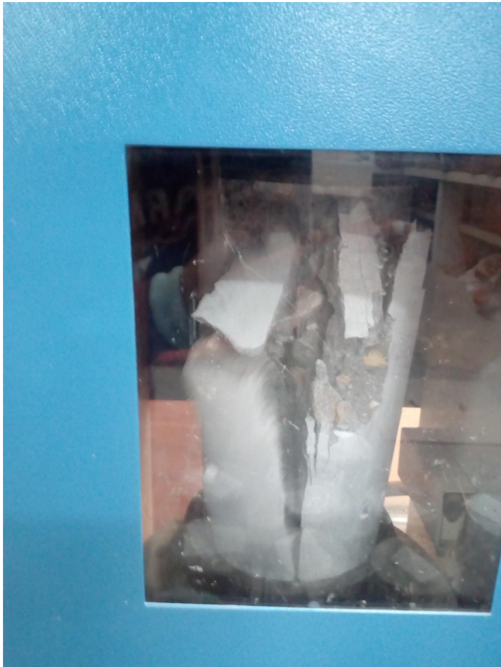
Rotura de probeta y/o testigo cilíndrico
