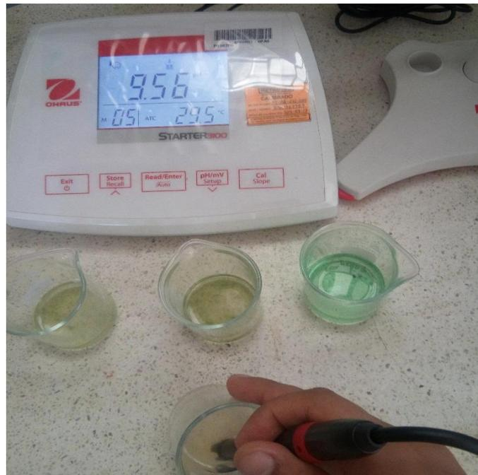
Figura E. Medición de pH y temperatura del cultivo de *Spirulina* sp.
