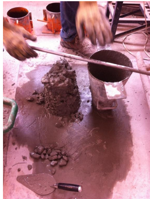
Foto N°20: Prueba del slump.
