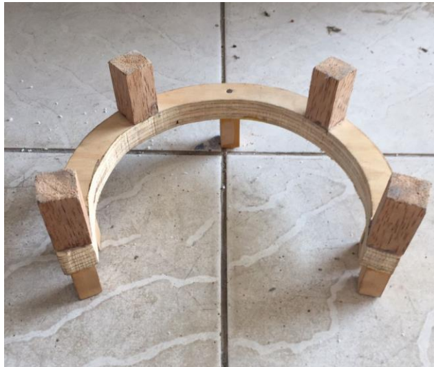
Foto N°4: Base de madera para equipo extensométrico.
