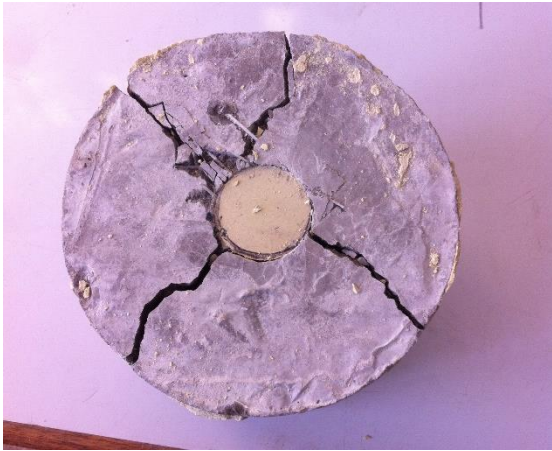
Foto N° 29: Patrón de fisuración del ensayo de doble punzonamiento.
