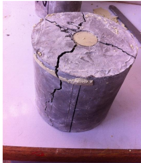
Foto N° 29: Patrón de fisuración del ensayo de doble punzonamiento.
