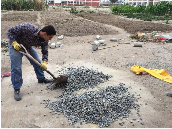
Foto N°9 Cuarteo del Material (a).
