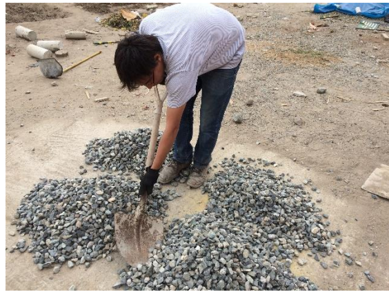
Foto N°10: Cuarteo del Material (b).
