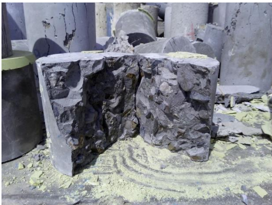
Foto N° 30: Distribución del agregado grueso (a), y las fibras (b) en la matriz del concreto.
