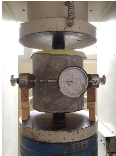
Foto N°6: Configuración del ensayo de doble punzonamiento.
