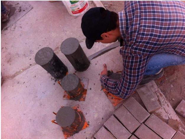
Foto N°21: Moldeo de Probetas testigo.
