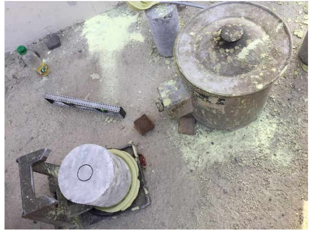
Foto N°26: Refrentado con azufre de testigos (a).
