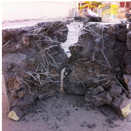
Foto N° 30: Distribución del agregado grueso (a), y las fibras (b) en la matriz del concreto.
