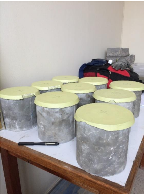
Foto N°27: Refrentado con azufre de testigos (b).
