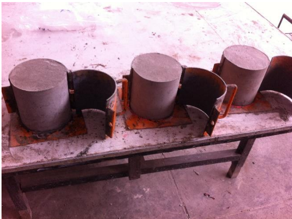
Foto N°23: Desencofrado de probetas testigo.
