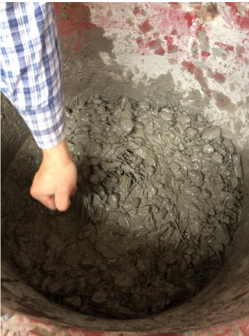
Foto N°19: Homogenizando las fibras con la mezcla de concreto.
