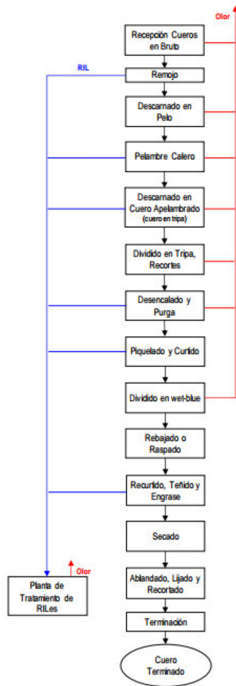
Figura N° 22 : Diagrama de flujo de una curtiembre, considerando los olores, a fin de mitigar con el sistema de tratamiento propuesto. Fuente : Mera Rivera . 2010.
