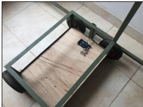
**Imagen N° 3-17.** Colocación de soporte de triplay sobre estructura.
