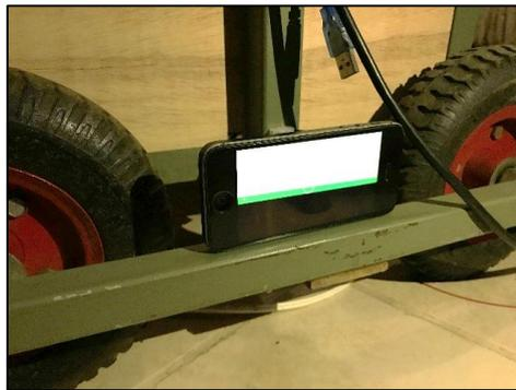
**Imagen N° 3-16.** Comprobación de perpendicularidad del brazo.
