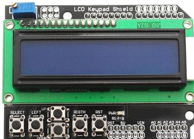
Imagen N° 2-2. Vista de Shield LCD.
