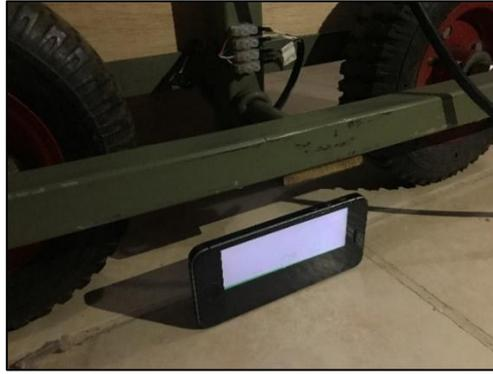
**Imagen N° 3-15.** Comprobación de perpendicularidad del brazo.
