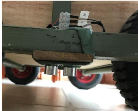
**Imagen N° 3-10.** Módulo ultrasonido adosado al perfil de acero que representa el brazo imaginario.
