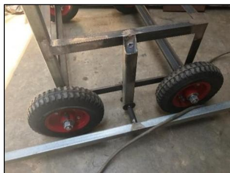
**Imagen N° 3-14.** Soldadura de brazo adosado.
