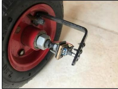
**Imagen N° 3-9.** Módulo encoder adosado a llanta del equipo.
