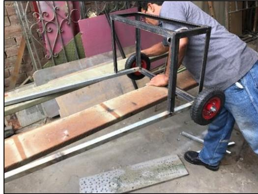
**Imagen N° 3-12.** Ensamblado de marco metálico.
