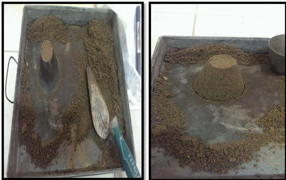
**Figura 6: Ilustración del Método del Cono de arena**
