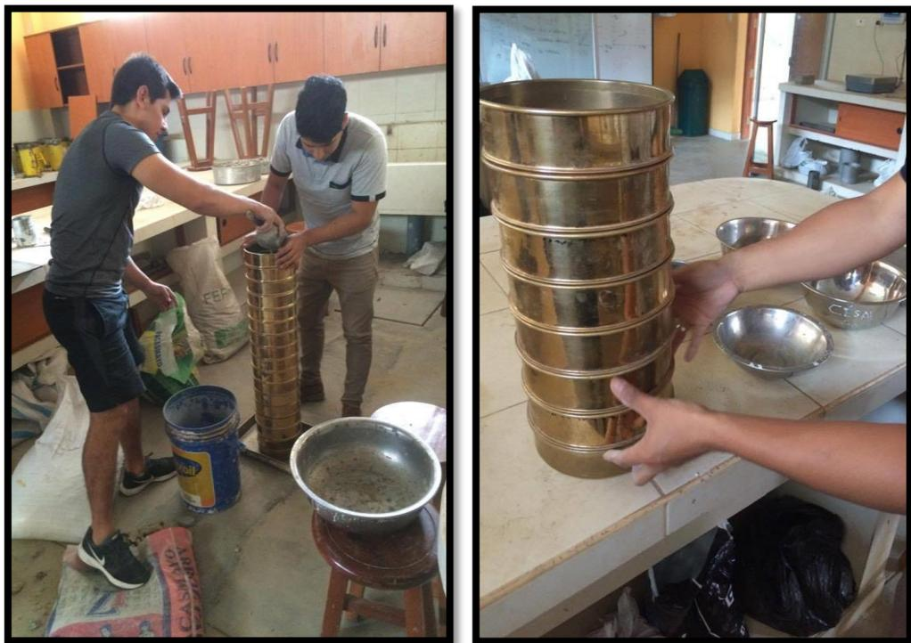
Figura 4: Ilustración del tamizado de los agregados
