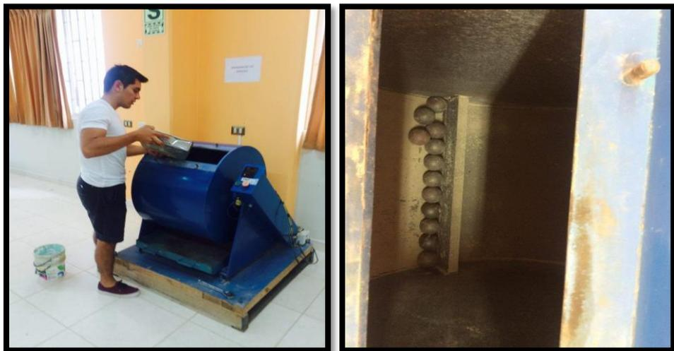
Figura 19: Colocación del Agregado Grueso en la Máquina de los Ángeles
