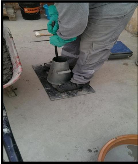
**Figura 9: Ensayo del Cono de Abrams Primera Parte**
