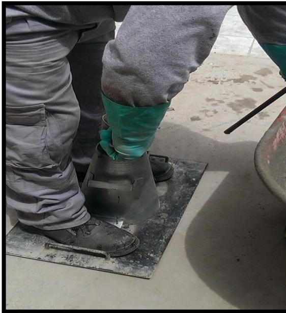
**Figura 10: Ensayo del Cono de Abrams Segunda Parte**
