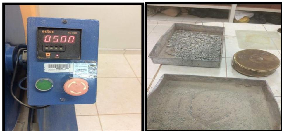
Figura 20: Número de vueltas de la máquina de los ángeles y separación de agregados con el tamiz #10
