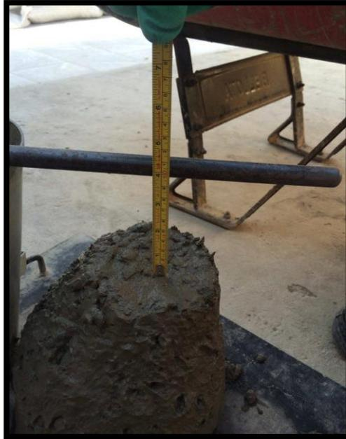
Figura 11: Ilustración del Asentamiento – Slump
