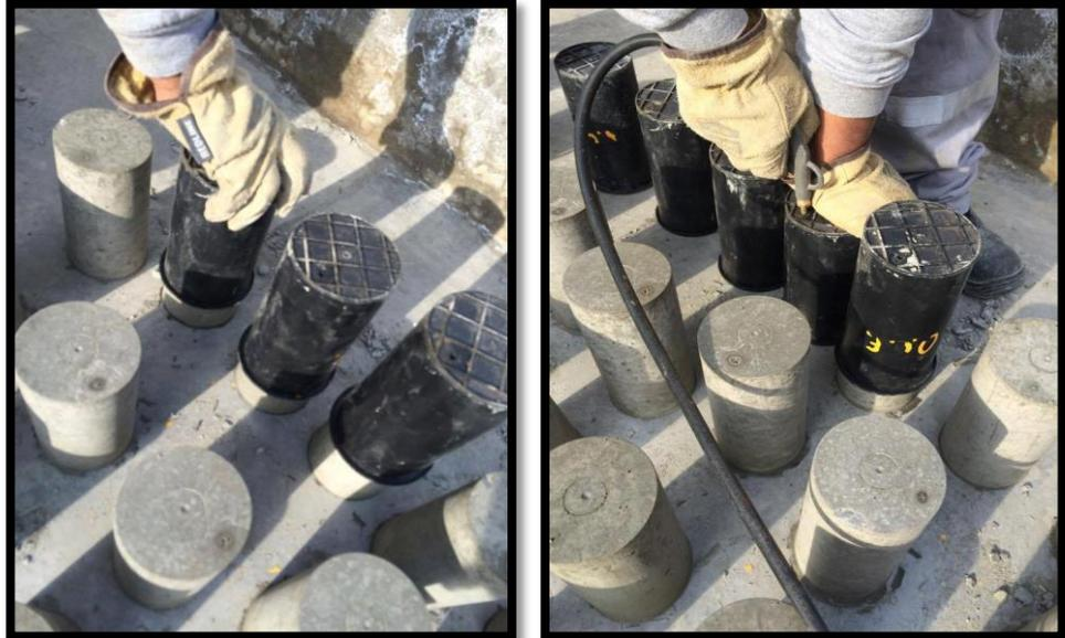
**Figura 16: Ilustración de Desmoldación de probetas**
