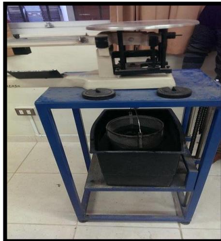
**Figura 5: Ilustración de la Balanza Hidrostática**
