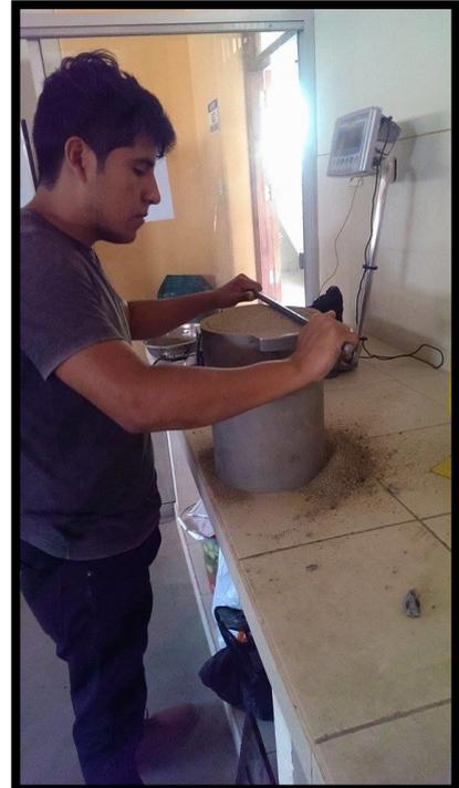
**Figura 8: Ilustración del Ensayo Peso (agregado fino – agregado grueso)**
