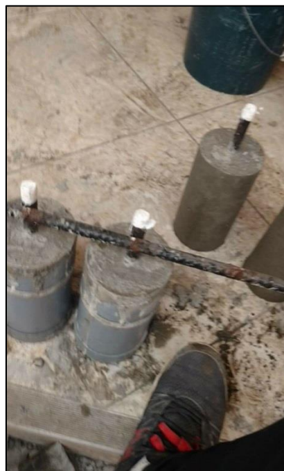
Foto 09: Elaboración de probetas con acero embebido en concreto.
