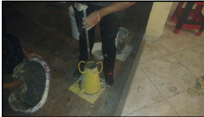
Foto 01.- Preparación de mezcla para prueba de SLUMP
