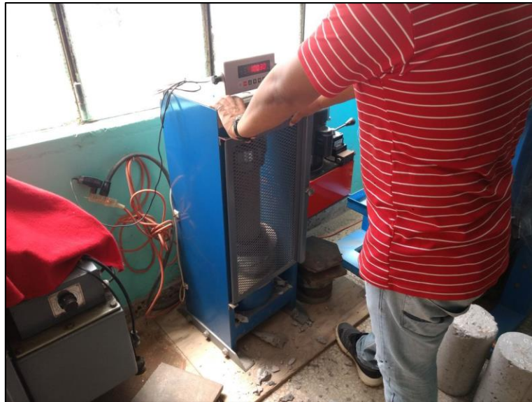
Foto 06.- Ensayo a la compresión normalizado
