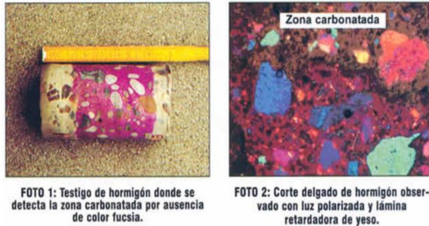
Figura 2.10 Carbonatación del Concreto (prueba con fenolftaleína).
