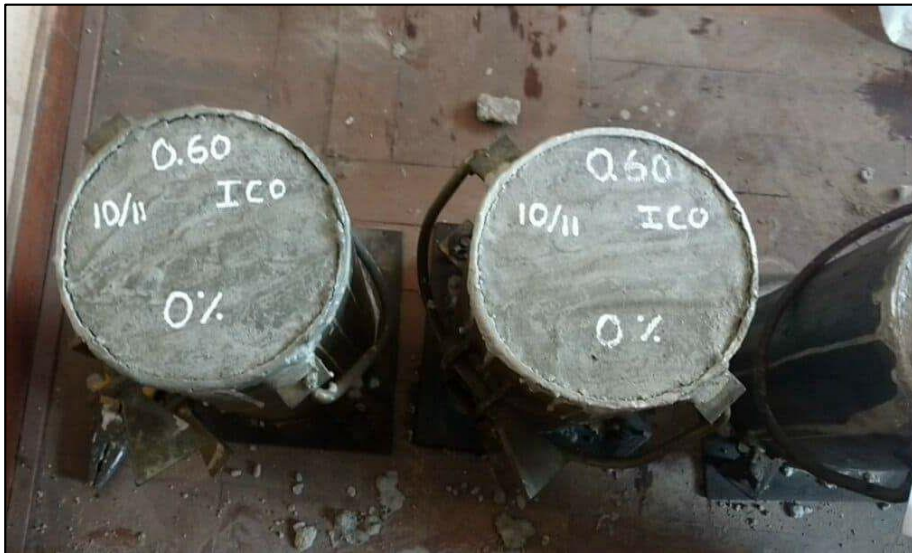
Foto 04.- Vaciado de Probetas para ensayo a Compresión.
