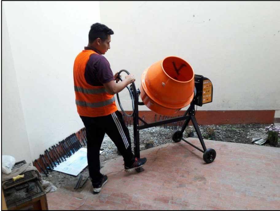
Foto 03.- Preparación de mezcla para Ensayo de Compresión
