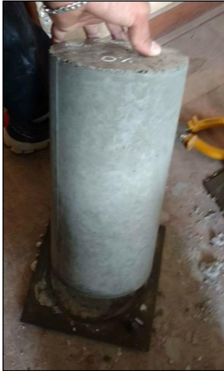
Foto 05.- Desencofrado de Probetas para su posterior curado.
