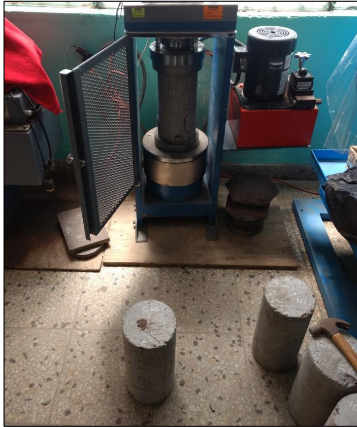
Foto 07.- Ensayo a la compresión normalizado
