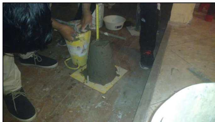
Foto 02.- Determinación del SLUMP (7cm)
