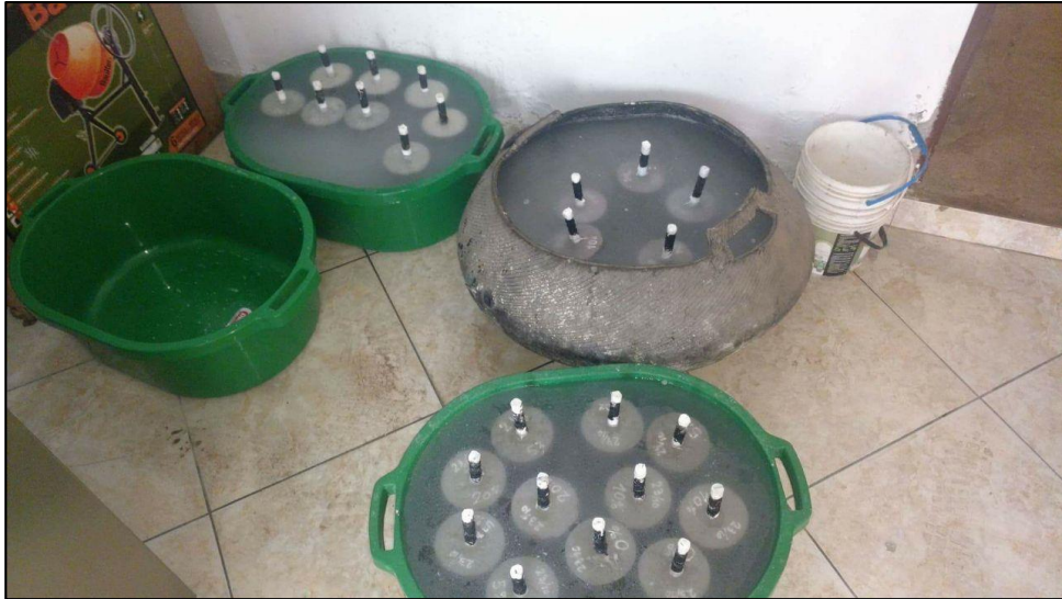
Foto 10: Curado de probetas en agua con cal después del vaciado.
