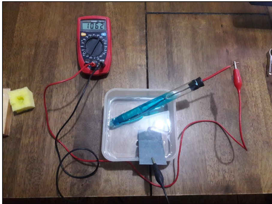
Foto 12: Verificando el electrodo de referencia Cu/CuSO 4
