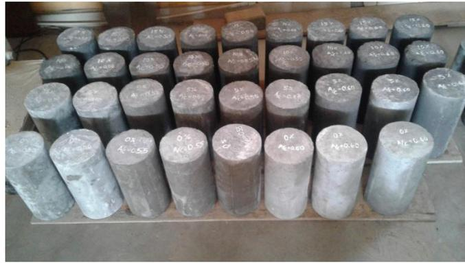
Figura A.03.4: Probetas para Ensayar Resistencia a la Compresión.
