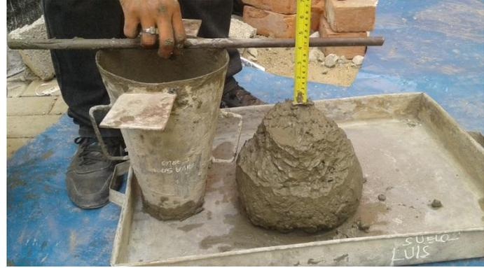
Figura A.03.1: Determinación del asentamiento del concreto en estado fresco.
