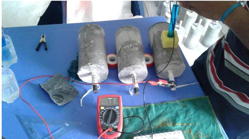
Figura 04.2: Midiendo el Potencial de Corrosión del Acero
