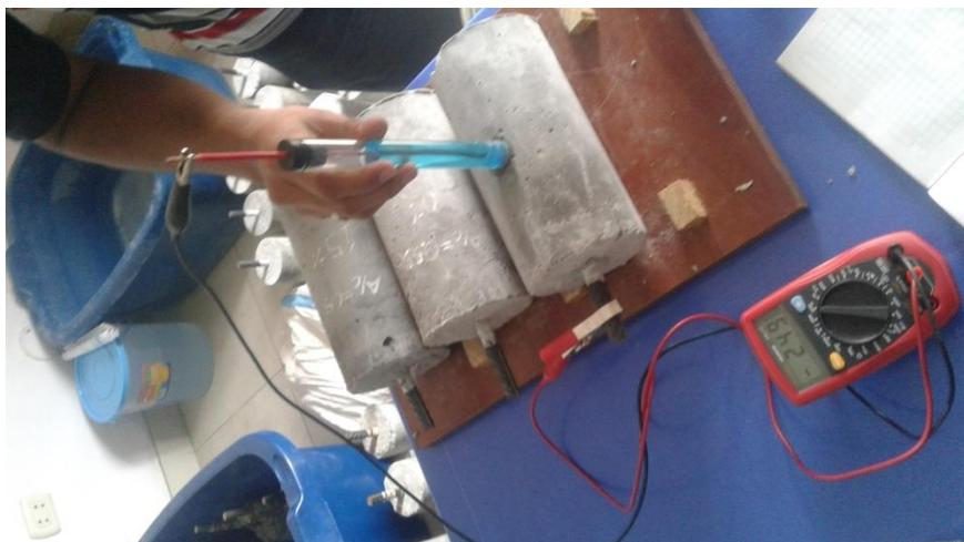
Figura 04.3: Midiendo el Potencial de Corrosión del Acero
