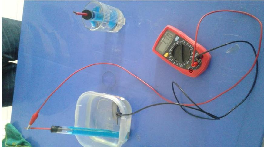
Figura 04.1: Verificando el electrodo de referencia Cu/CuSO<sub>4</sub>
